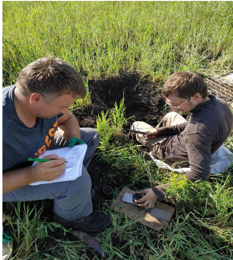
Рисунок 21 – Определение плотности сложения почвы на тестовом полигоне №1, 2021 год
