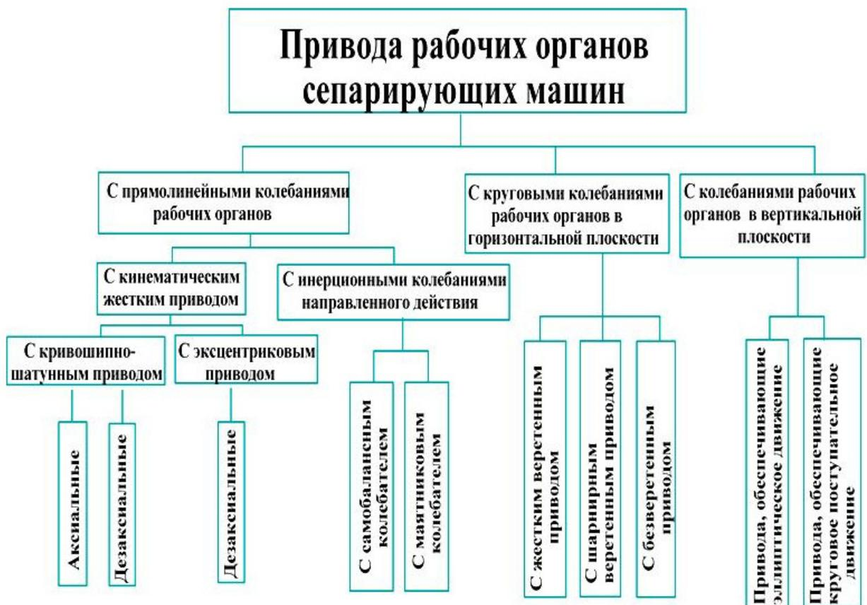
Рисунок 1.2 – Классификация приводов рабочих органов сепарирующих машин
