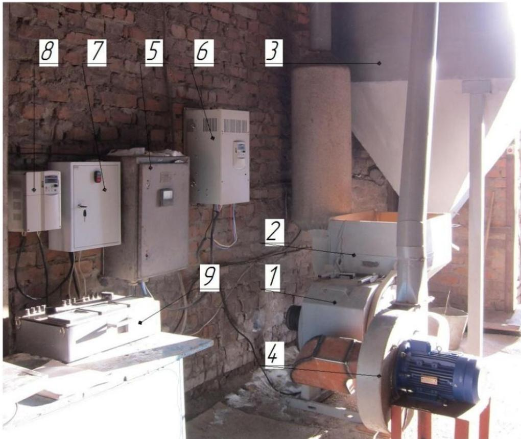
1 - дробильная камера; 2 - приемный бункер; 3 - бункер накопитель; 4 - вентилятор; 5,7 - щит управления электродвигателем дробилки и вентилятора; 6,8 - частотный преобразователь; 9 - измерительный комплекс К-505
