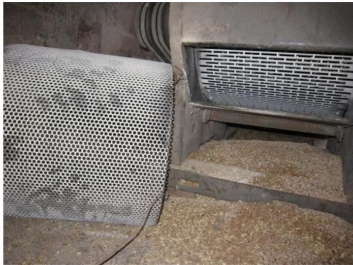
Рисунок 4.2 - Стандартное решето с круглыми отверстиями в сравнении с регулятором «живого» сечения
