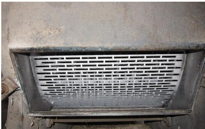
Рисунок 3.3 - Регулятор «живого» сечения в дробильной камере
