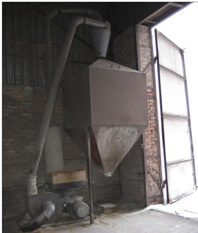
Рисунок 4.1 - Молотковая дробилка КДУ-2,0
