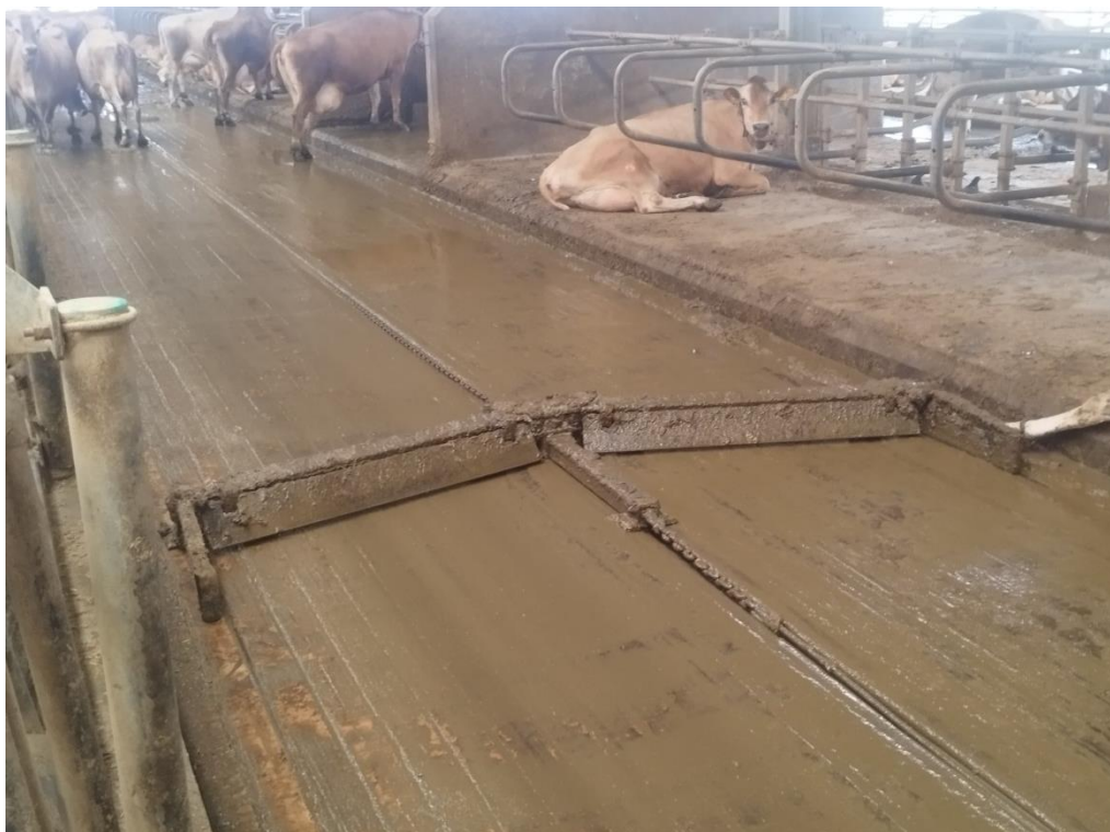
Рисунок 3 – Скребок дельта-скреперной установки.
