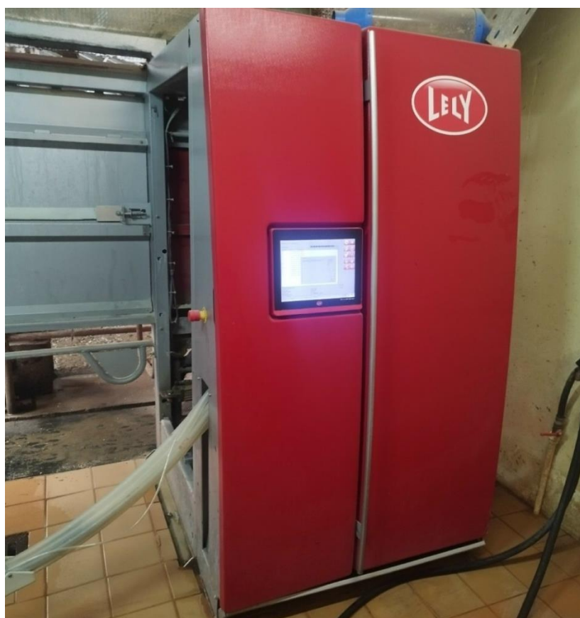
Рисунок 5 – Центральный блок роботизированной доильной установки «Lely».
