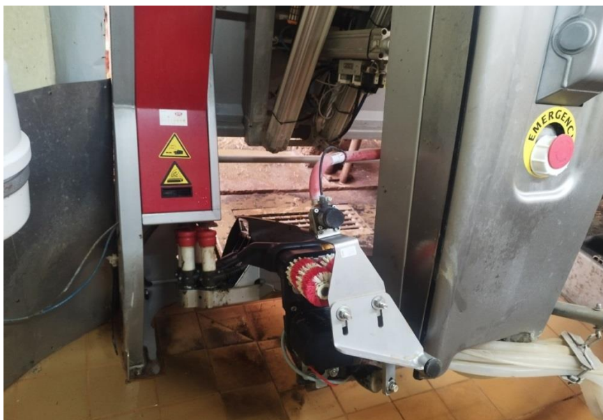
Рисунок 4 – Рычаг доильного аппарата роботизированной доильной установки «Lely».
