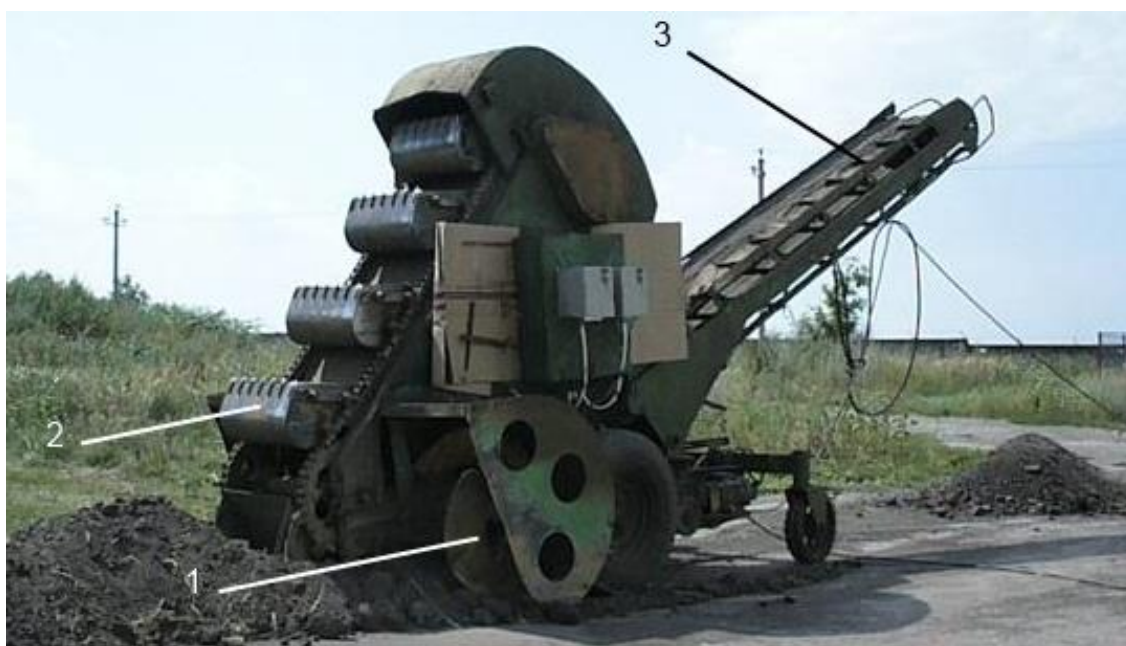
1 – подающий шнек, 2 – ковшовый элеватор, 3 – ленточный транспортер
