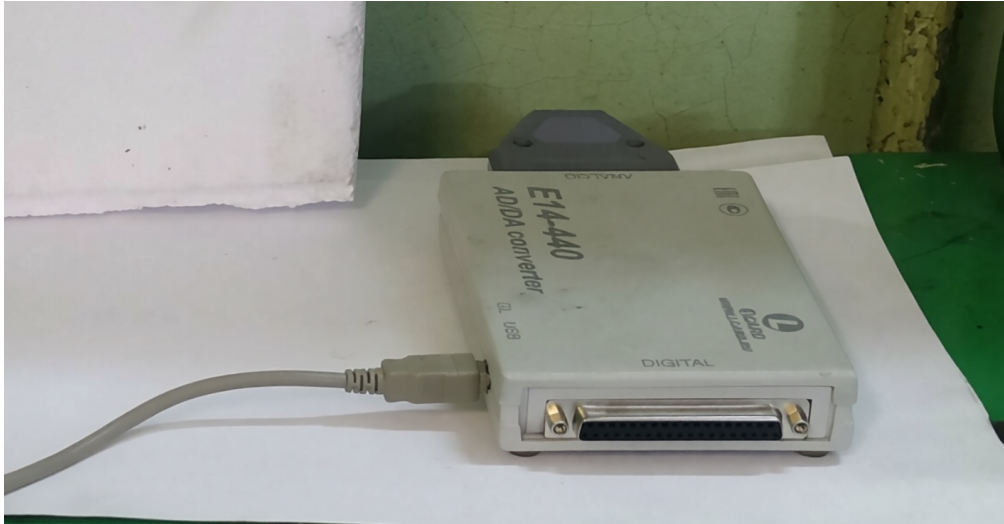
Рисунок 3.5 — Аналого-цифровой преобразователь L-Card E14-440 во время проведения эксперимента
