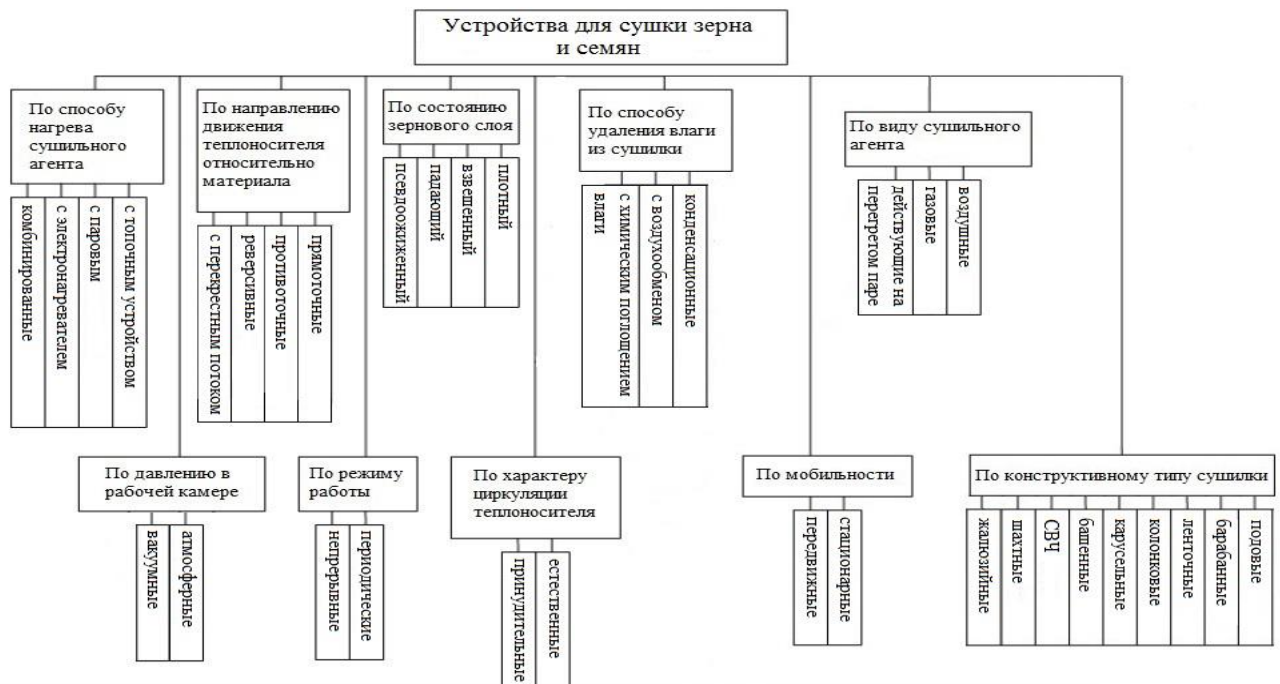
Рисунок 1.2 – Классификация устройств для сушки зерна и семян
