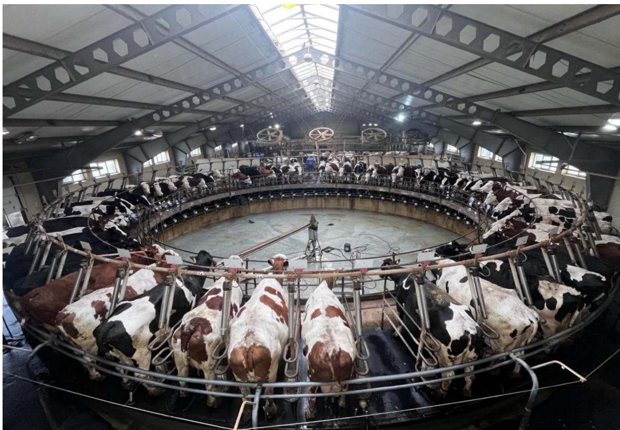
Рисунок 3. Доильная установка «Карусель»
