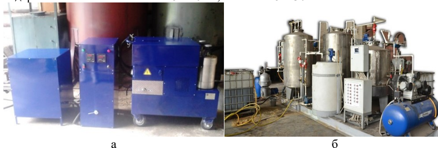
Рисунок 18 – Экспериментальная установка очистки топлива (а) и опытно-промышленная установка УБТРМ-600 (б)
