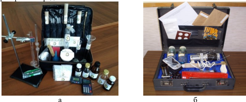
Рисунок 17 – Портативные экспресс-лаборатории контроля качества топлив – ЭЛТ (а) и смазочных материалов – ЭЛМ (б)
