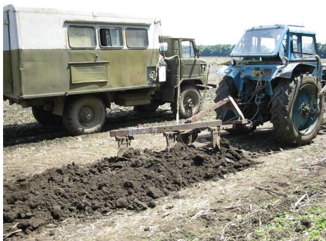
Рисунок 11 – Общий вид испытываемого трактора-макета в агрегате с навесным плугом ПЛН 3-35 и измерительным комплексом лаборатории ТЛ-2 на базе автомобиля ГАЗ-66
