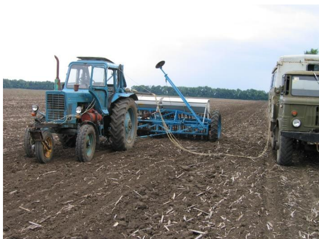
Рисунок 13 – Общий вид испытываемого трактора-макета в агрегате с прицепной сеялкой СЗ-5,4А и измерительным комплексом лаборатории ТЛ-2 на базе автомобиля ГАЗ-66
