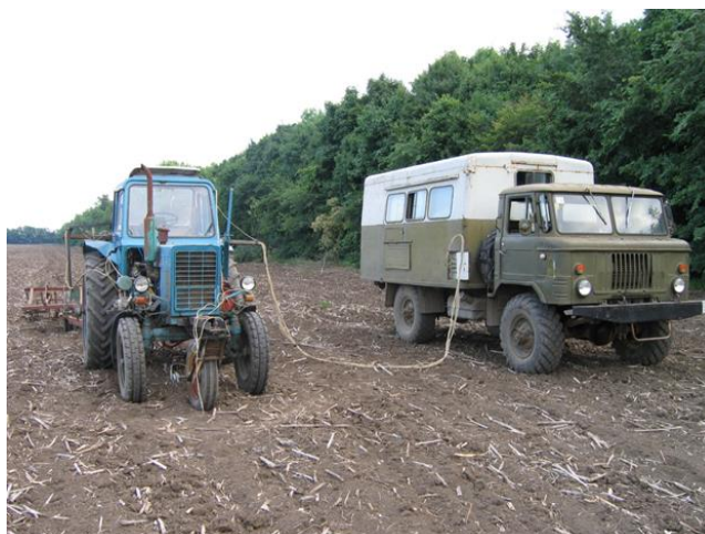
Рисунок 12 – Общий вид испытываемого трактора-макета в агрегате с прицепным культиватором и измерительным комплексом лаборатории ТЛ-2 на базе автомобиля ГАЗ-66
