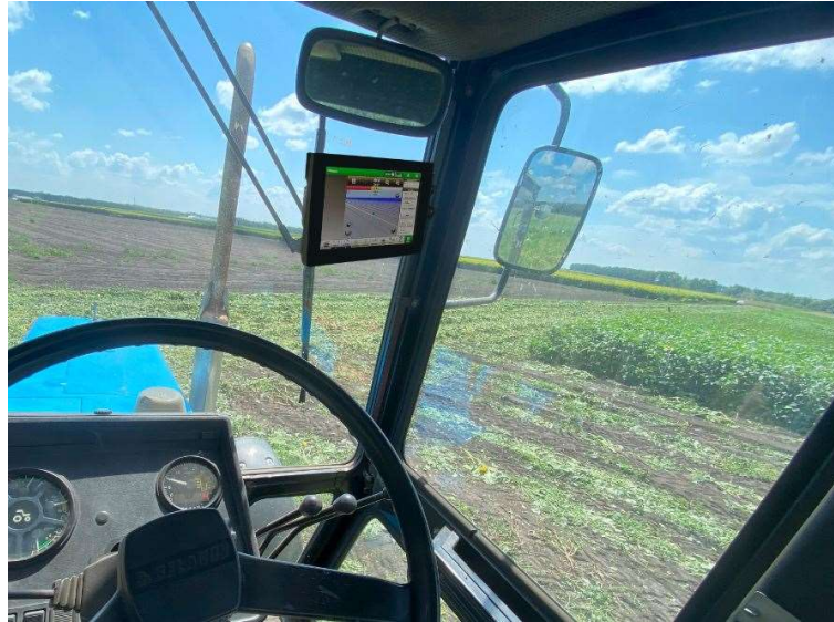
Рисунок 3.9 – Монитор GreenStar-4240 в кабине трактора Беларус-80.1
