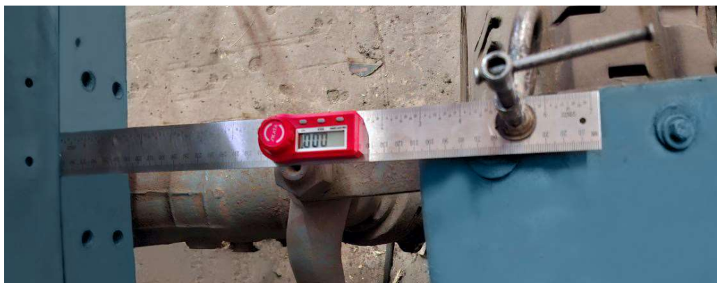
Рисунок 3.5 – Измерение угла поворота колеса электронным угломером SKATA-200
