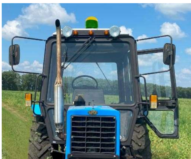
Рисунок 3.8 – Навигационная система Starfire-3000 на тракторе Беларус-80.1
