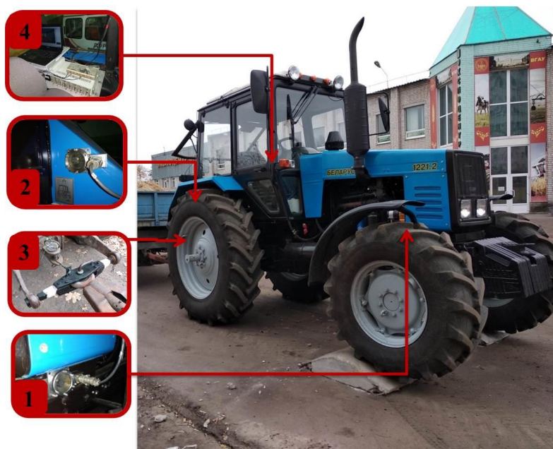
Рисунок 3.9 — ТТА с оборудованием для дорожно-полевых испытаний
