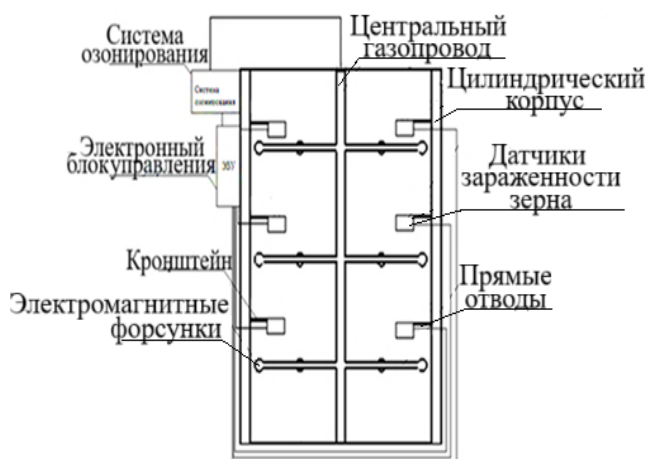
Рисунок 4 – Схема устройства для хранения зерна и семян зерновых культур
