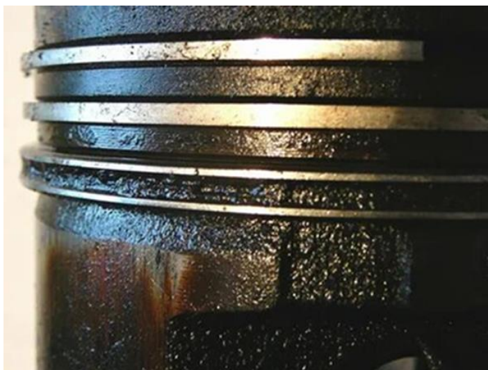
Рисунок 1.3 – Загрязнения и нагар на поршне двигателя в зоне поршневых колец
