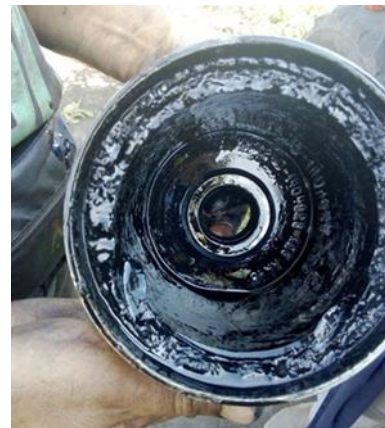
Рисунок 4.28 – Состояние стакана ротора
