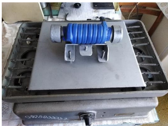
Рисунок 3.3 – Устройство для предварительного анализа моющих свойств масла с добавками
