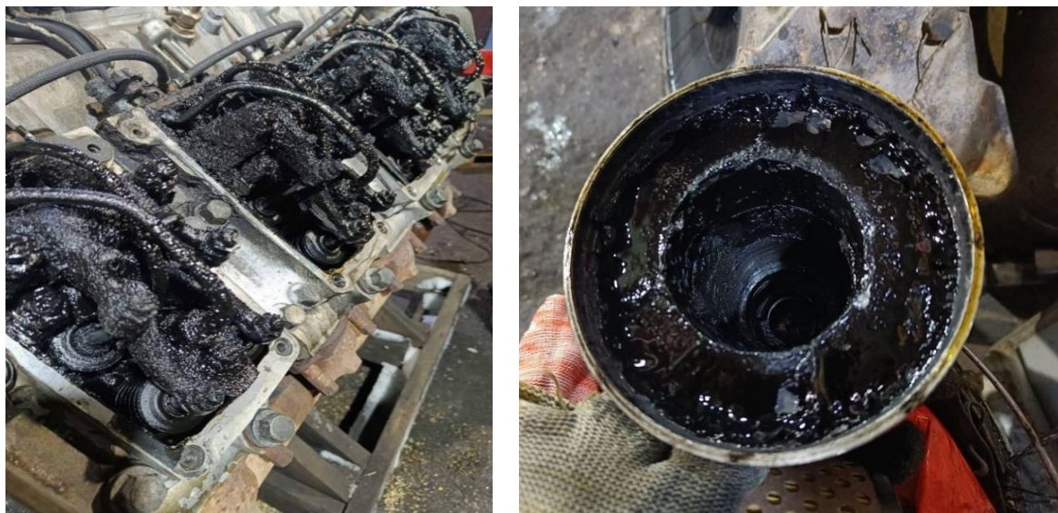
Рисунок 1.6 – Внешний вид образующихся шламовых отложений
