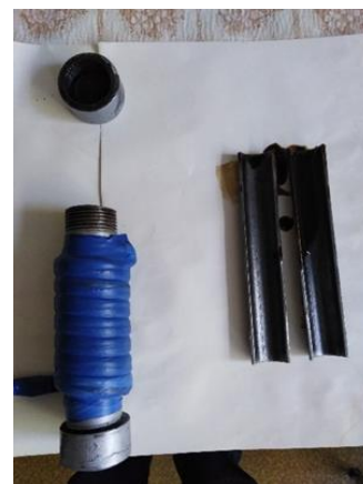
Рисунок 3.3 – Устройство для предварительного анализа моющих свойств масла с добавками
