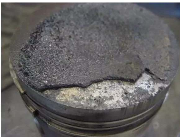
Рисунок 1.2 – Поршень двигателя с повышенным угаром масла
