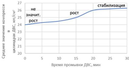
Рисунок 5 - Зависимость изменения компрессии в цилиндрах двигателя от времени промывки системы смазки
