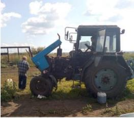
Рисунок 21 - Прогрев двигателя, слив отработанного масла
