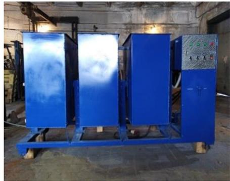
Рисунок 18 - Общий вид установки для очистки отработанных масел от загрязнений и получения на их основе масел для промывки ДВС
