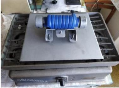
Рисунок 7 - Устройство для предварительного анализа моющих свойств масла с добавками
