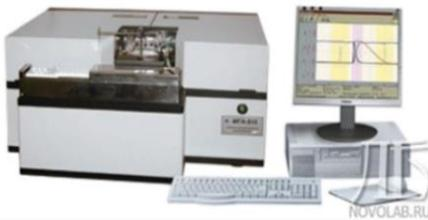
Рисунок 11 - Атомно-адсорбционный спектрометр МГА-915 М
