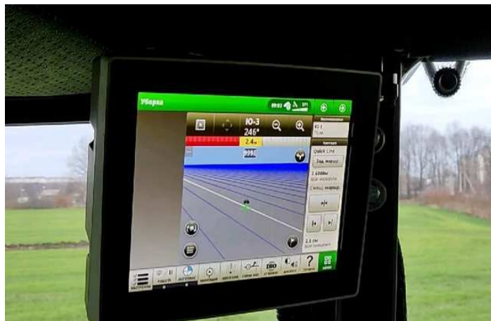
Рисунок 3.11 – Монитор GreenStar-4240 в кабине трактора Беларус-1221.2
