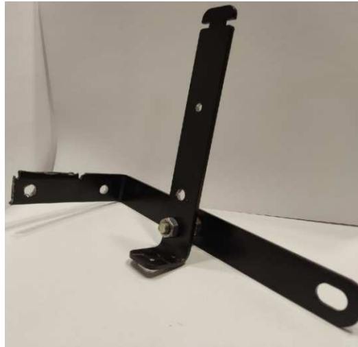
Рисунок 3.13 – Кронштейн крепления подруливающего устройства
