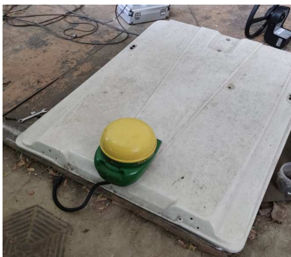
Рисунок 3.10 – Модуль навигационной системы Starfire-3000, установленный на крыше трактора Беларус-1221.2
