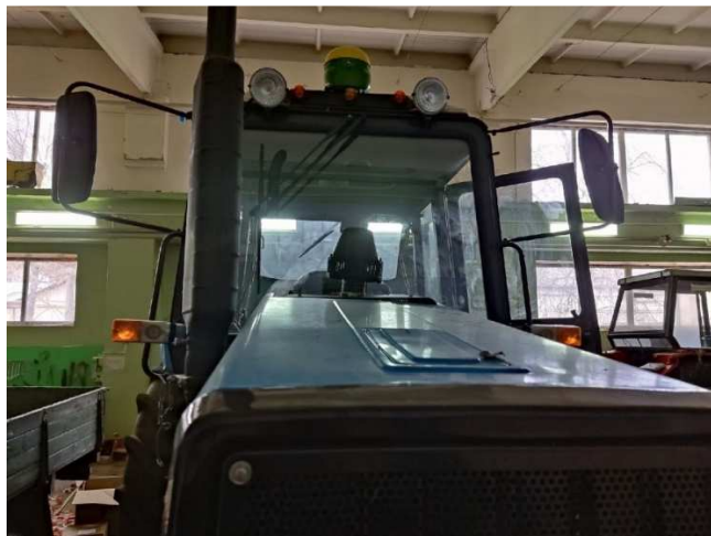
Рисунок 3.9 – Навигационная система Starfire-3000 на тракторе Беларус-1221.2
