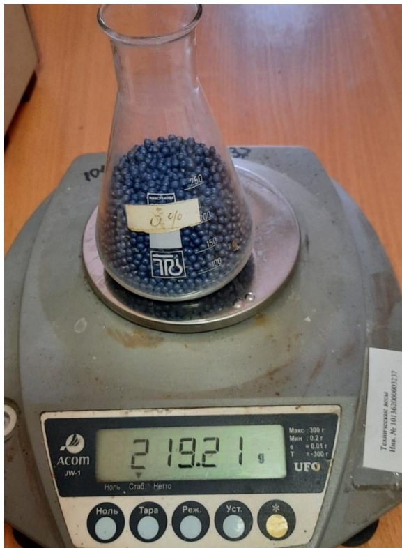
Рисунок 3.7 – Установка для определения объемной массы семян
