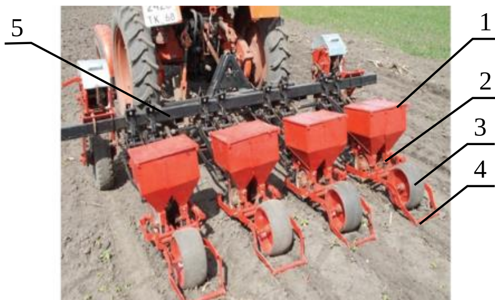
1 – бункер, 2 – совмещенные высевающие аппараты, 3 – прикатывающий каток, 4 – загортач, 5 – рама и навесное устройство трактора
