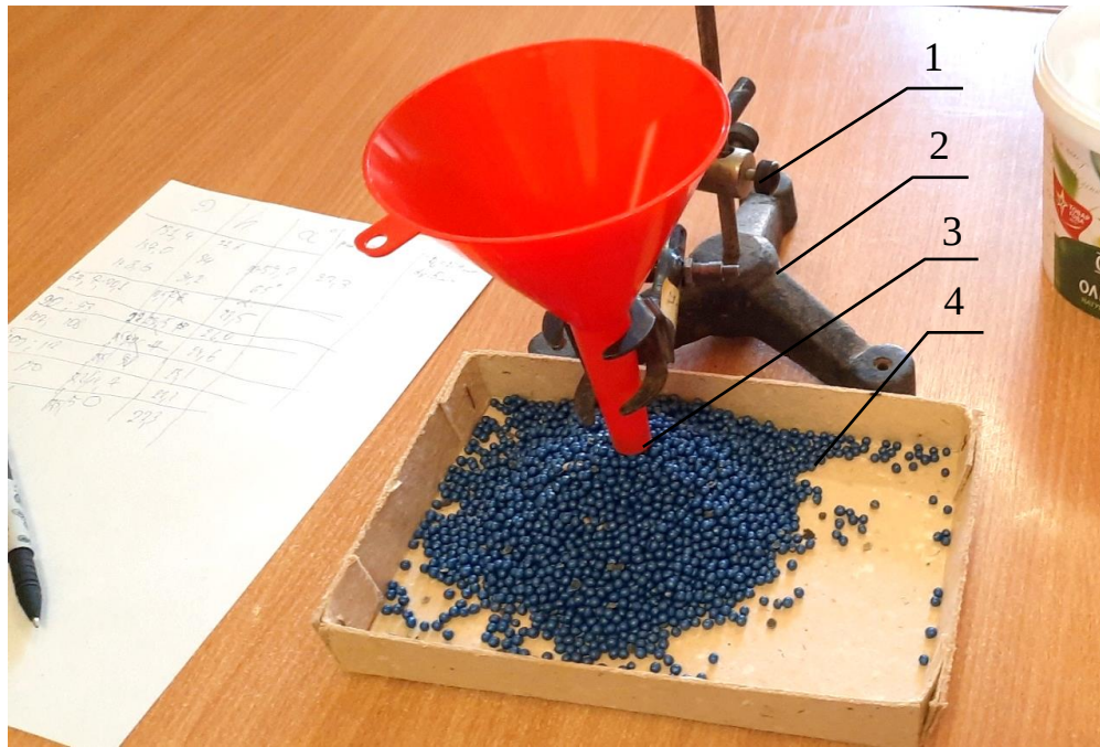
1 – подъемный механизм, 2 – подставка, 3 – воронка, 4 – основание
