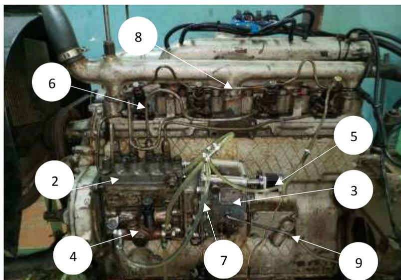
Рисунок 3.8. Элементы топливopодающей системы
