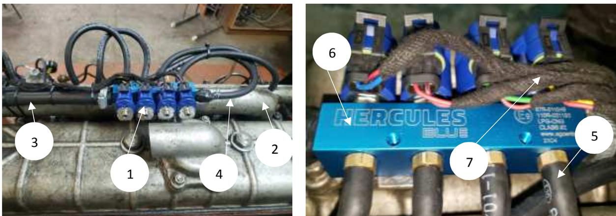
Рисунок 3.10. Установка газовых форсунок
