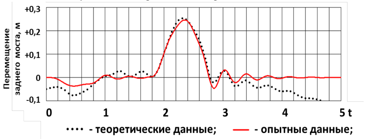
Рисунок 4.17 – Вертикальные перемещения заднего моста
