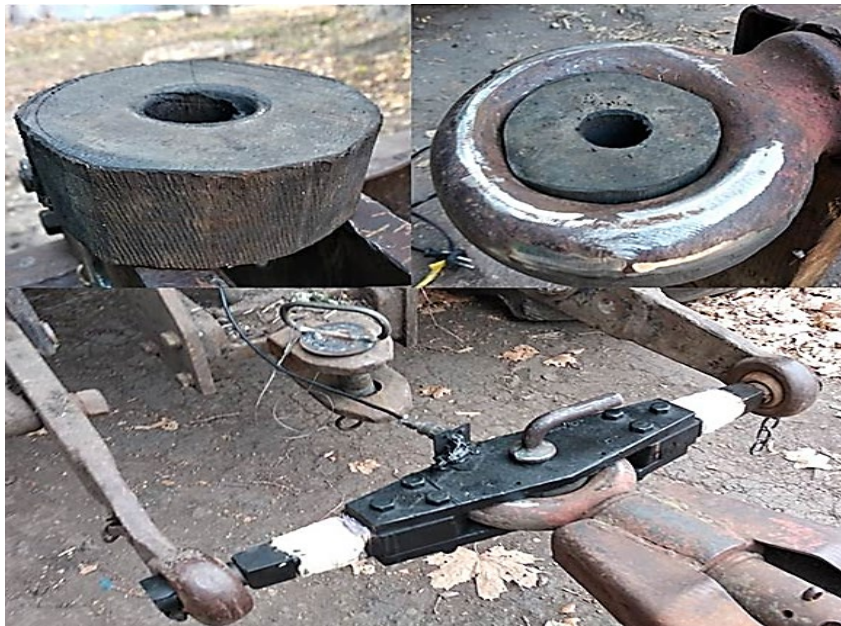
Рисунок 3.26 – Демпфер для снижения ударных нагрузок
