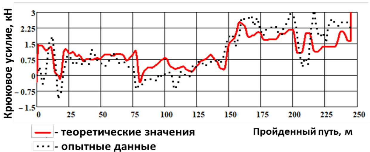
Рисунок 4.20 – Сходимость теоретических значений и практически полученных данных крюкового усилия
