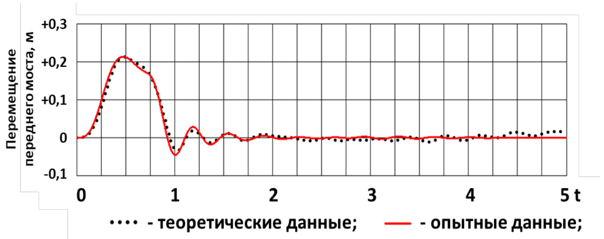
Рисунок 4.15 – Вертикальные перемещения переднего моста
