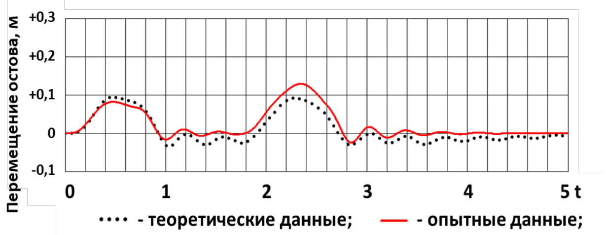
Рисунок 4.16 – Вертикальные перемещения остова
