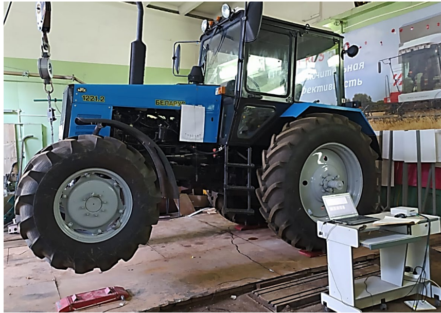
Рисунок 3.21 – Определение вертикальной координаты центра тяжести трактора
