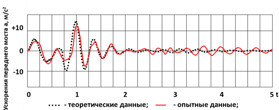
Рисунок 4.9 – Ускорения переднего моста при переезде единичной неровности
