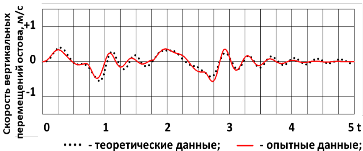
Рисунок 4.13 – Скорость вертикальных перемещений остова при переезде единичной неровности
