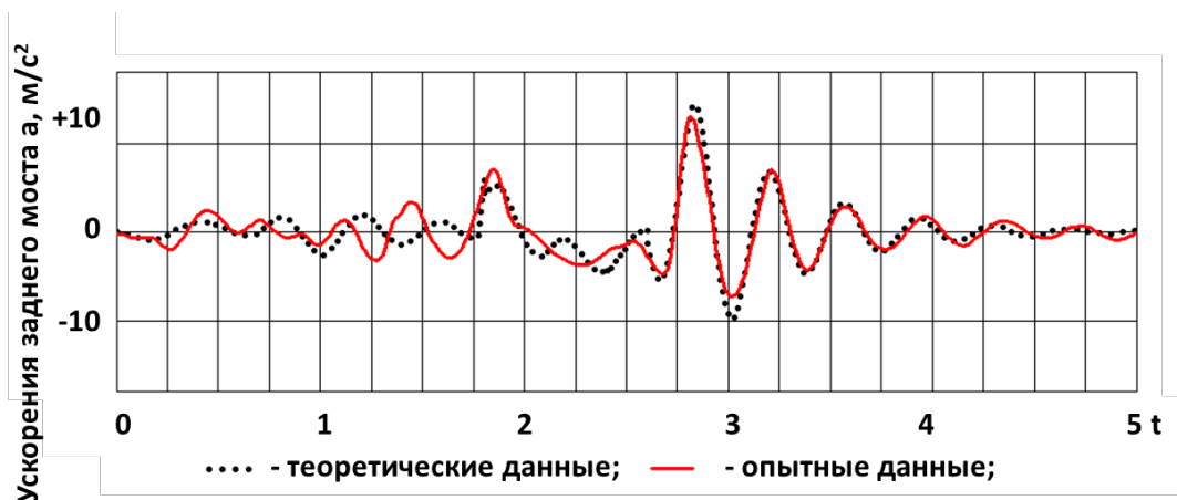
Рисунок 4.11 – Ускорения заднего моста при переезде единичной неровности
