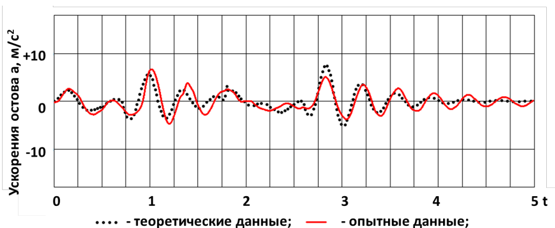
Рисунок 4.10 – Ускорения остова при переезде единичной неровности
