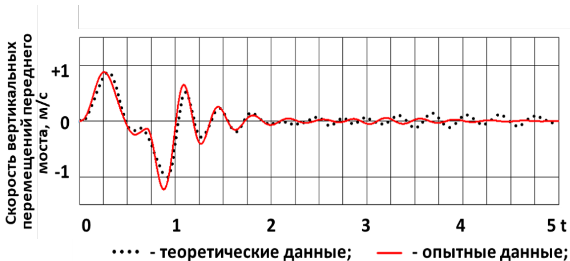
Рисунок 4.12 – Скорость вертикальных перемещений переднего моста при переезде единичной неровности
