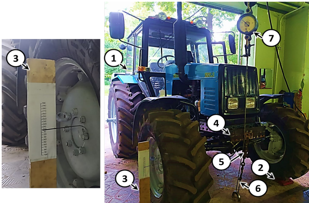
1 – трактор; 2 – тензометрические весы; 3 – измерительная доска; 4 – передний свес трактора; 5 – тяга; 6 – трос соединительный; 7 – динамометр растяжения
