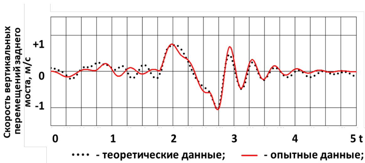
Рисунок 4.14 – Скорость вертикальных перемещений заднего моста при переезде единичной неровности
