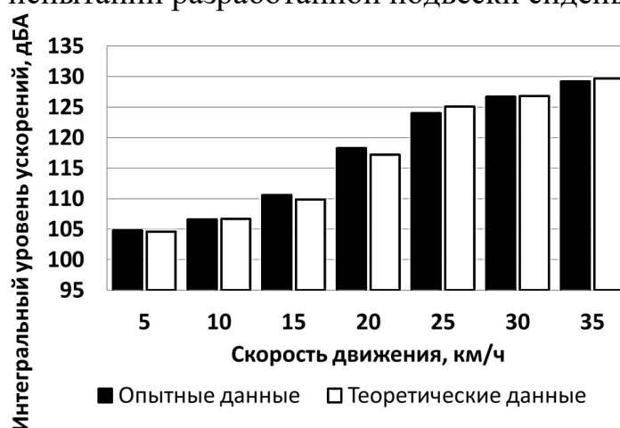
Рисунок 6 – Опытные и теоретические данные интегрального уровня виброускорений на различных скоростях движения
