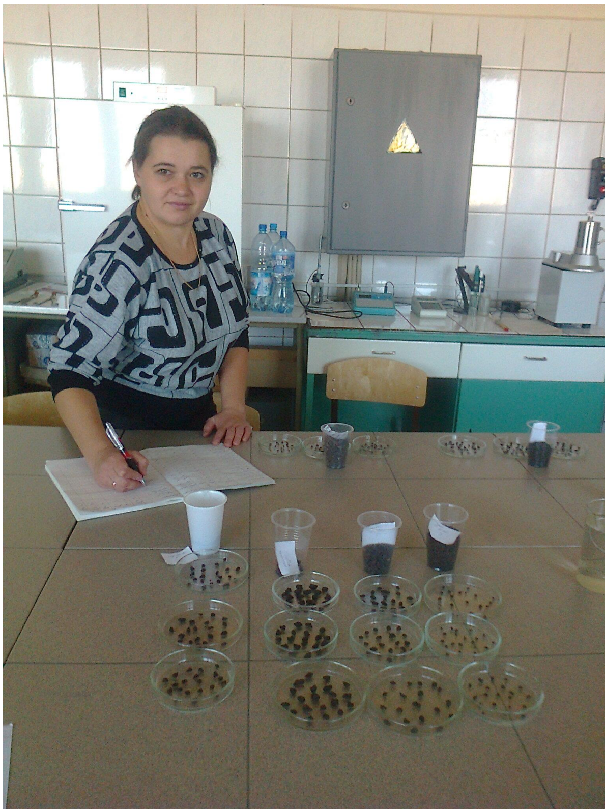
Рисунок 2 – Определение водоустойчивости почвенных образцов
