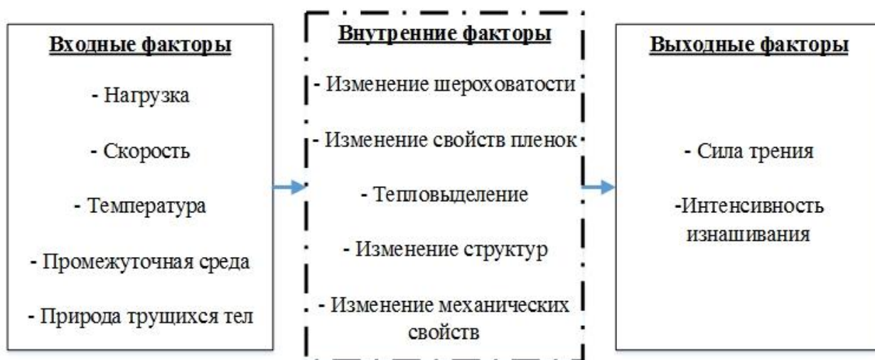
Рисунок 1.2 – Схема факторов, влияющих на износ рабочих поверхностей шнека
