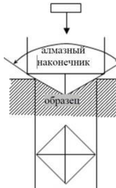
Рисунок 3.4 – Схема измерения твердости и микротвердости
