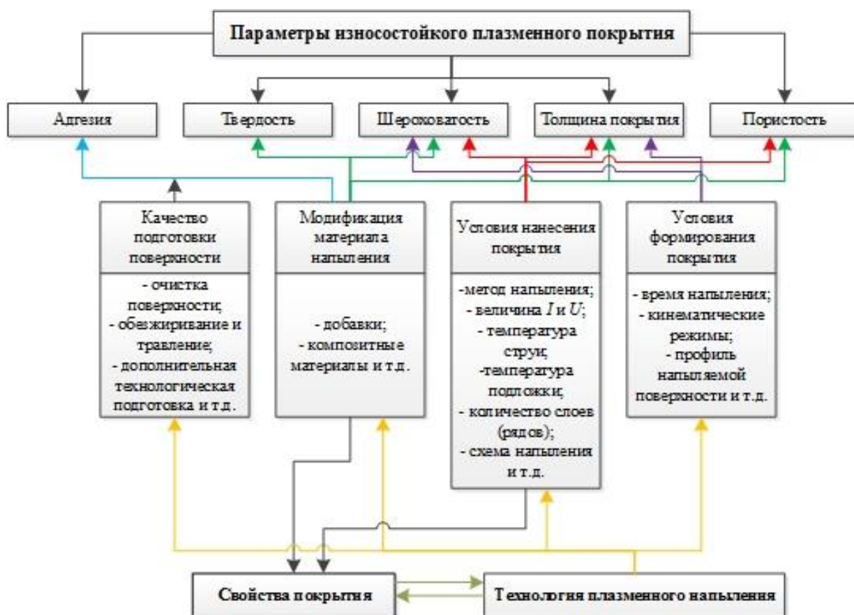
Рисунок 1.8 – Влияние параметров и режимов плазменного напыления на технологические параметры покрытия
