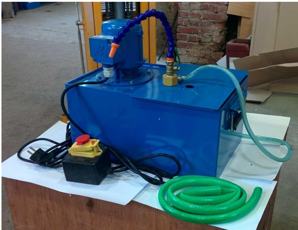
Рисунок 5.3 – Система подачи СОЖ Universal CB-13L
