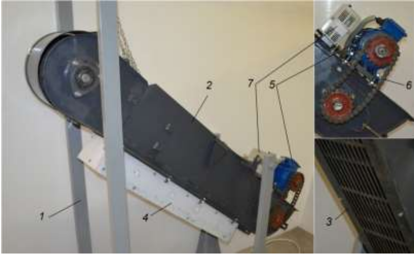
Рисунок 11 – Экспериментальная установка, имитирующая работу скребкового плавающего транспортера наклонной камеры зерноуборочного комбайна: 1 – рама; 2 – колосовой элеватор; 3 – съемное решетчатое днище; 4 – емкость для сбора зернового вороха; 5 – электродвигатель; 6 – цепная передача; 7 – частотный преобразователь
