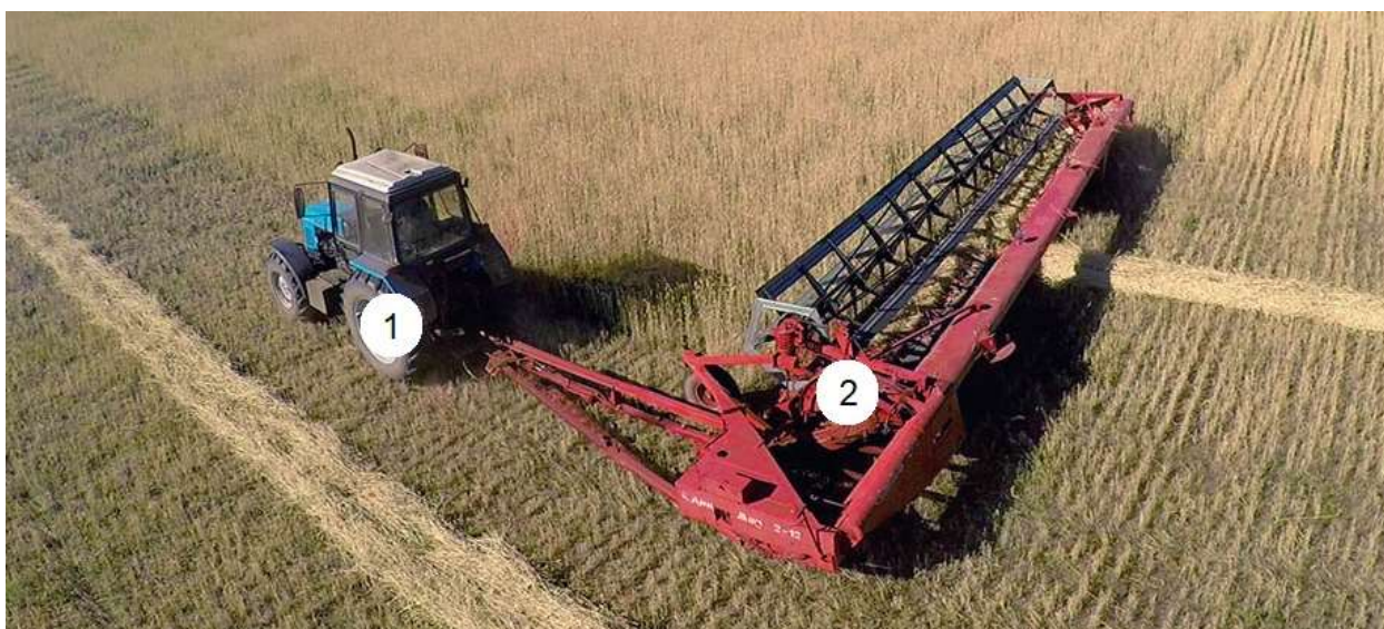
Рисунок 1.4 – Скашивание и укладка хлебов в валок при раздельном способе уборки: 1 – трактор; 2 – валковая жатка
