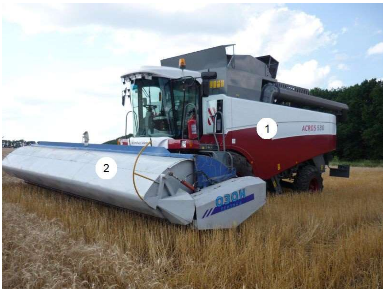
Рисунок 1.10 – Общий вид зерноуборочного комбайна в агрегате с очесывающей жаткой «ОЗОН»: 1 – зерноуборочный комбайн; 2 – очесывающая жатка
