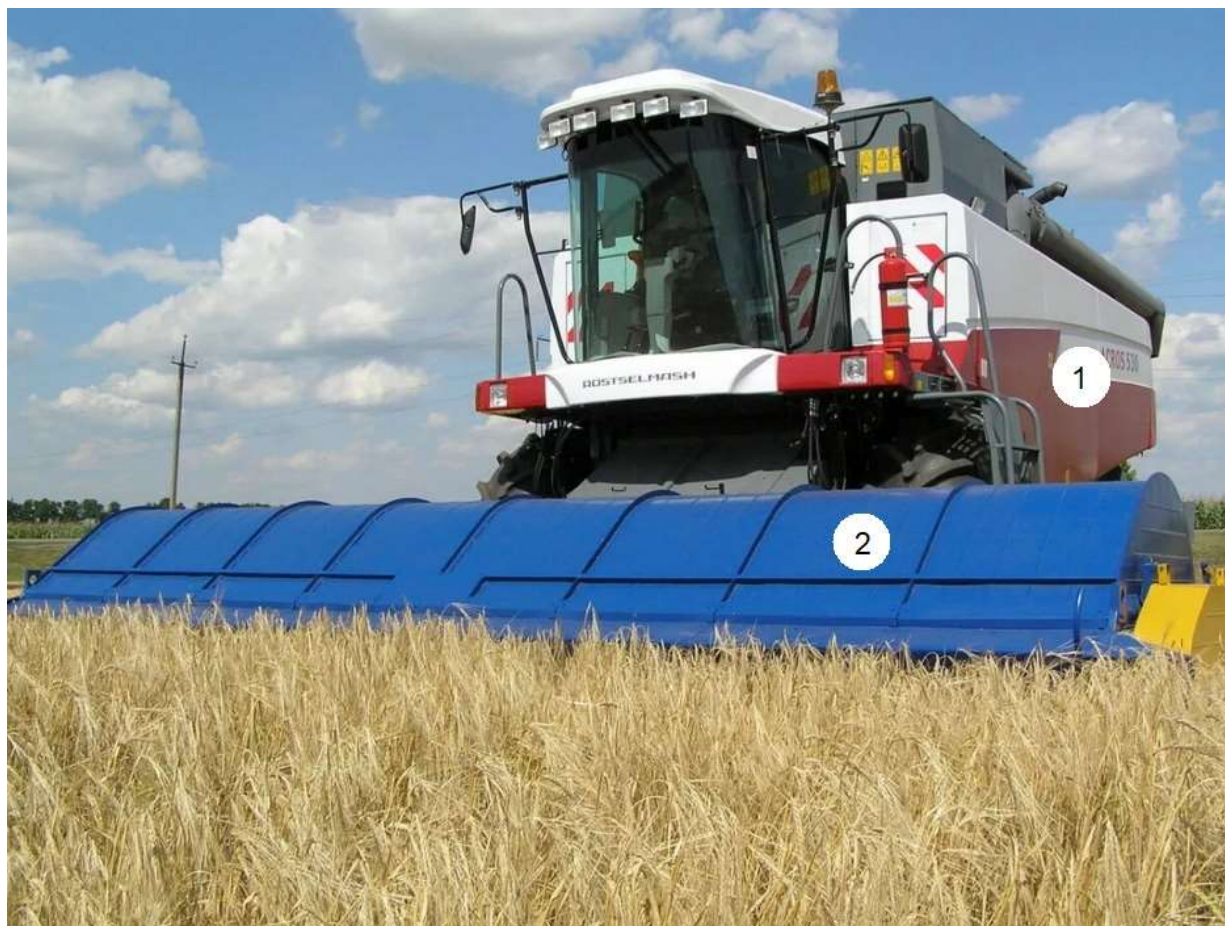
Рисунок 1.9 – Общий вид зерноуборочного комбайна в агрегате с очесывающей жаткой «Славянка УАС»: 1 – зерноуборочный комбайн; 2 – очесывающая жатка
