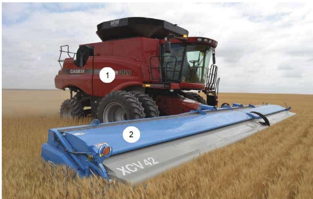
Рисунок 1.8 – Общий вид зерноуборочного комбайна в агрегате с очесывающей жаткой «Shelbourne Reynolds» серии XCV: 1 – зерноуборочный комбайн; 2 – очесывающая жатка
