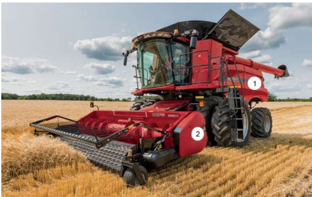
Рисунок 1.5 – Подбор и обмолот валков при раздельном способе уборки: 1 – зерноуборочный комбайн; 2 – подборщик
