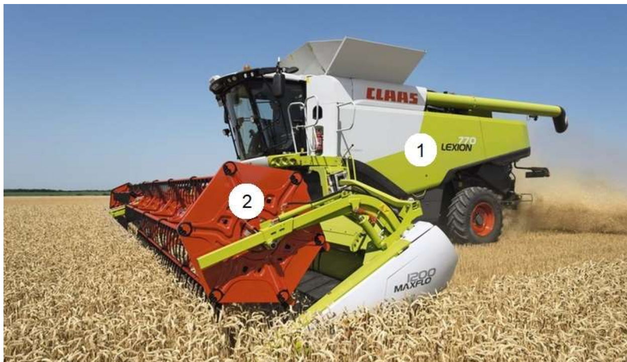
Рисунок 1.3 – Общий вид зерноуборочного комбайна, оснащенного жаткой для однофазного способа уборки: 1 – зерноуборочный комбайн; 2 – жатка для зерновых культур
