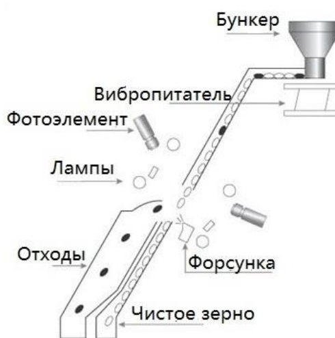
Рисунок 4.6 – Принцип работы фотосепаратора
