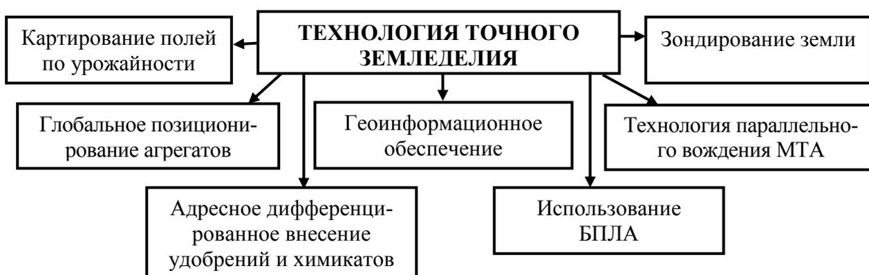
Рисунок 22 – Элементы технологии точного земледелия
