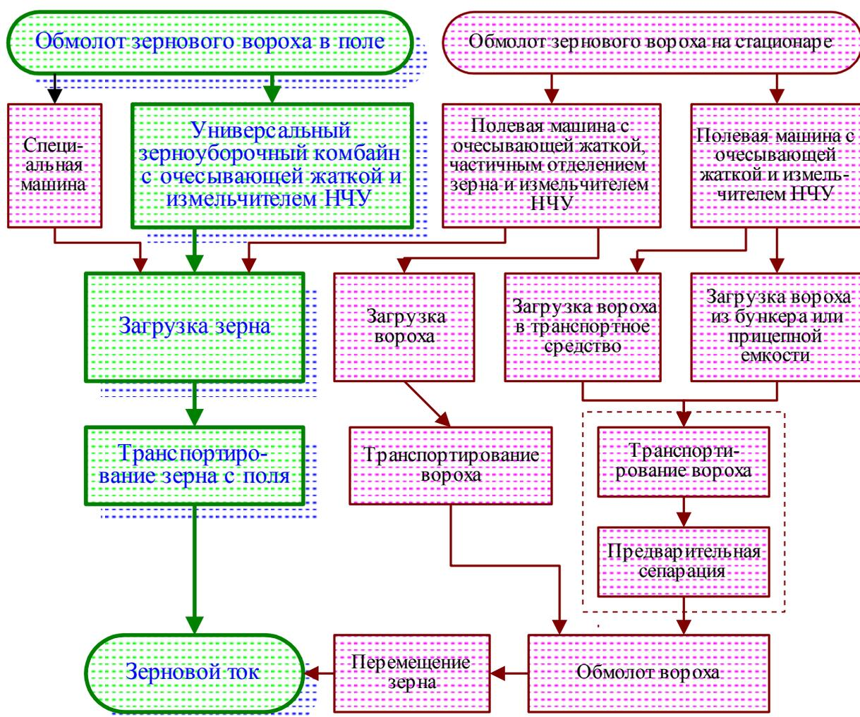
Рисунок 5 – Схема вариантов технологий уборки зерновых колосовых культур очесом на корню [36, 80]
