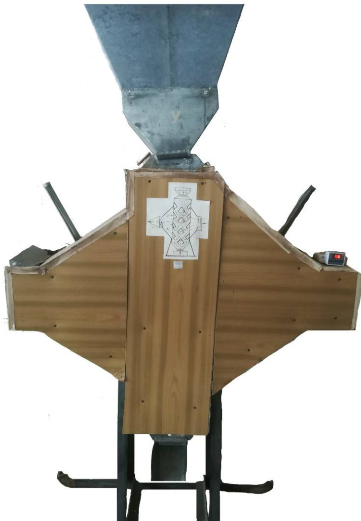
Рисунок 4.4 – Экспериментальная шахтная зерносушилка
