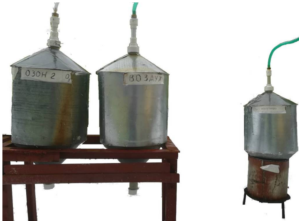
Рисунок 4.6 – Экспериментальные металлические силоса с коническим дном
