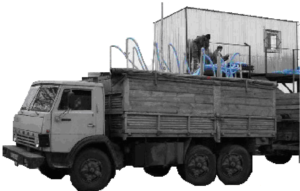
Рисунок 2.5 – Озонное обеззараживание зерна в кузове грузового автомобиля КАМАЗ-55102 в Республике Беларусь [246]
