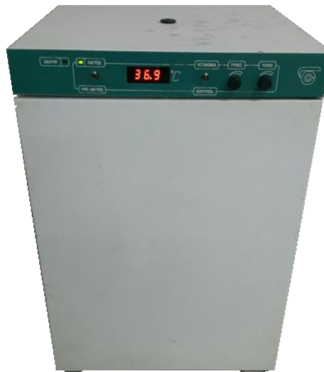
Рисунок 4.8 – Электрический термостат суховоздушный ТС-1/20 СПУ
