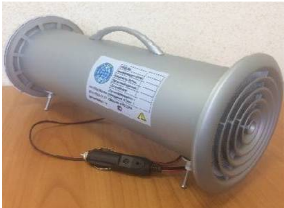
Рисунок 2.7 – Озонатор, работающий от бортовой электрической сети автомобиля
