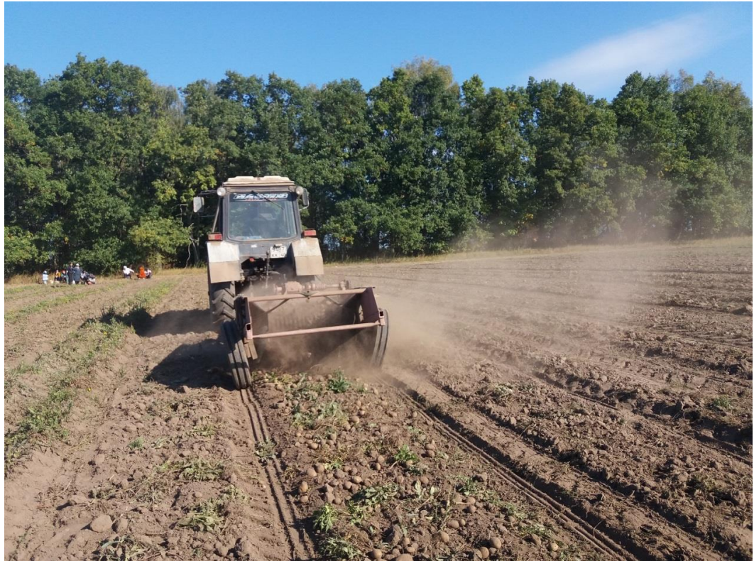
Рисунок 52 – Фрагмент проведения опытов по определению полноты сепарации примесей S_c ротационным картофелекопателем
