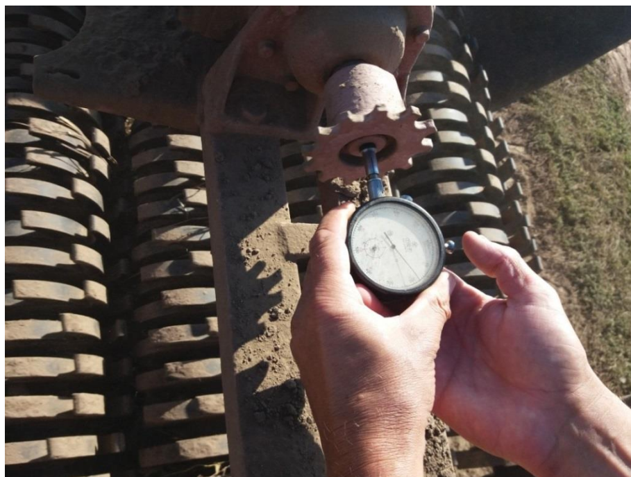
Рисунок 48 – Измерение частоты вращения ротационных рабочих органов n_p и битера n_b
