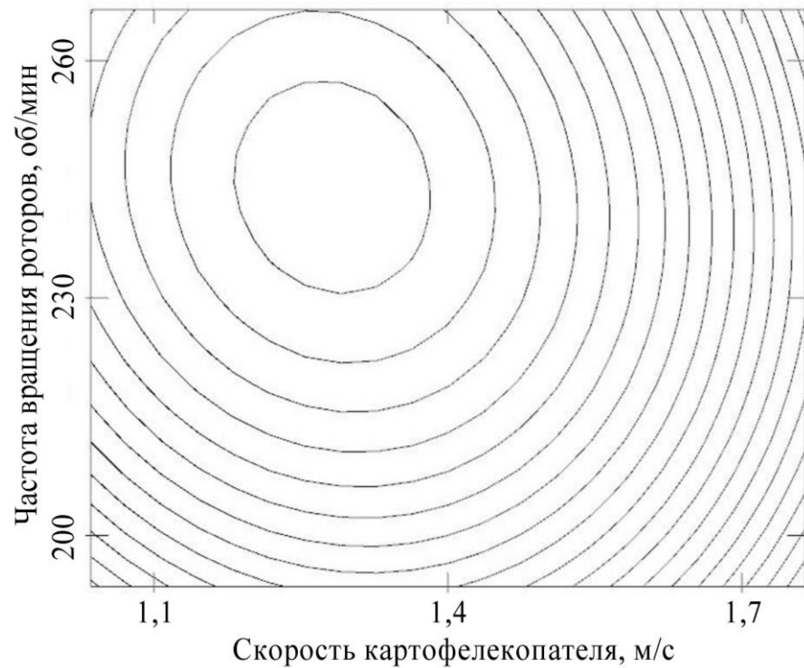
Рисунок 54 – Поверхность отклика и ее контурный график, характеризующие полноту сепарации S_c при изменении V_k , n_p и при постоянном значении фактора n_o
