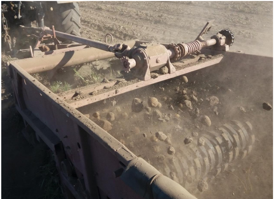
Рисунок 51 – Фотоснимок перемещения компонентов картофельного пласта со значительным отрывом от ротационных рабочих органов
