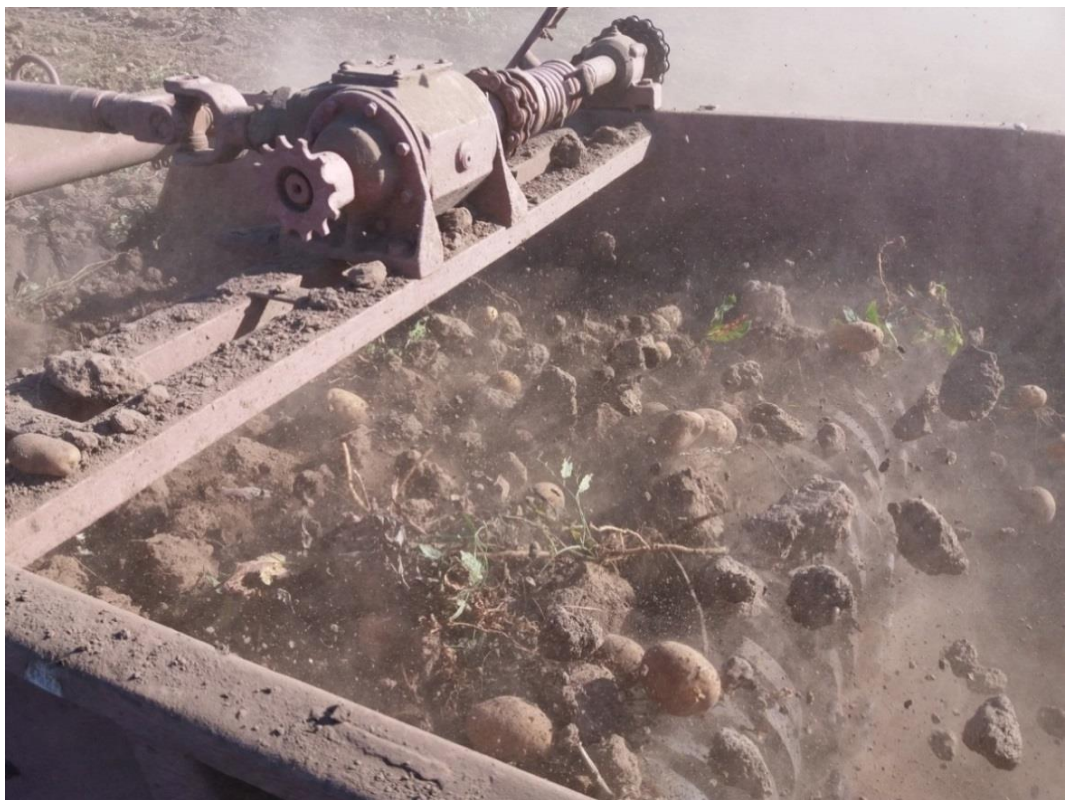
Рисунок 50 – Фотоснимок устойчивого перемещения компонентов картофельного пласта и высокой сепарирующей способности
