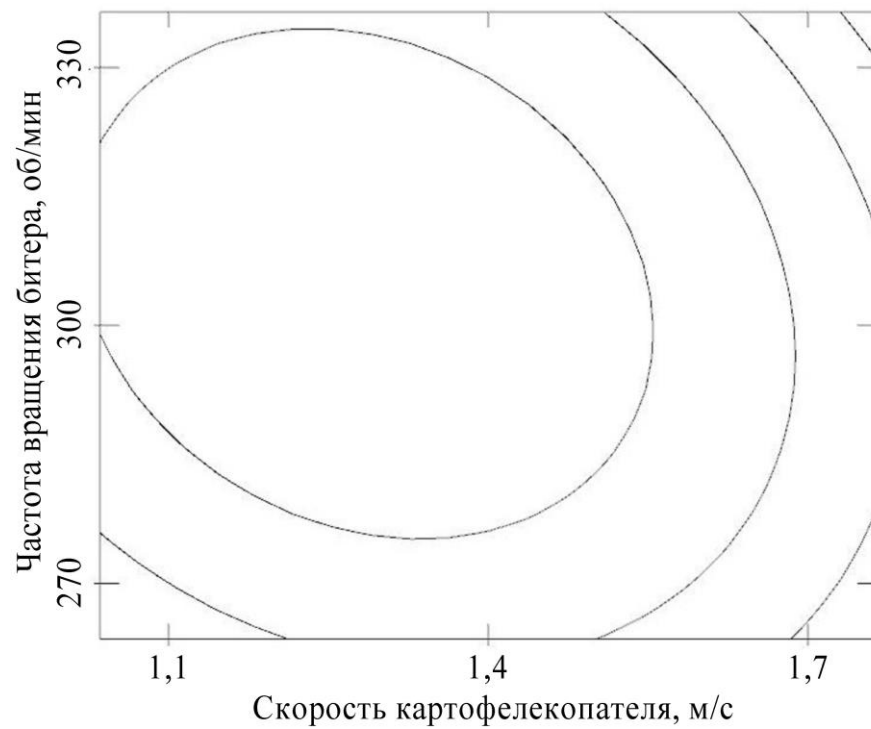
Рисунок 53 – Поверхность отклика и ее контурный график, характеризующие полноту сепарации S_c при изменении V_k , n_b и при постоянном значении фактора n_p
