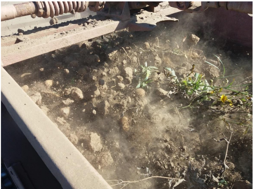
Рисунок 49 – Фотоснимок перемещения картофельного пласта со сгруживанием и снижением сепарирующей способности
