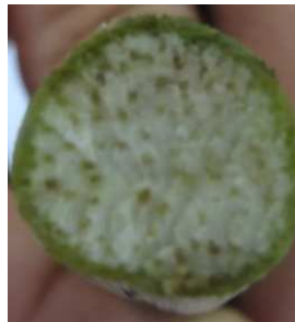
Рисунок 3.6 – К методике определения площади поперечного разреза армирующего и основного слоя стебля
