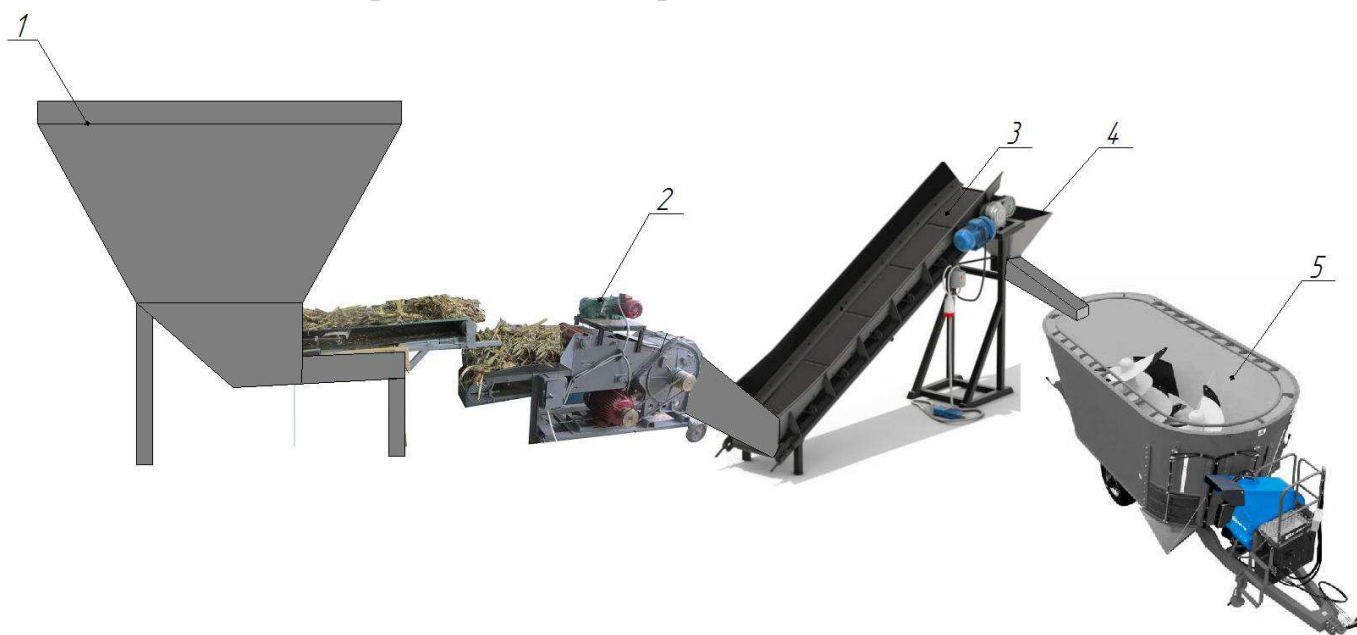
Рисунок 5.1 – Схема расположения измельчителя стебельчатых кормов в кормоцехах хозяйств: 1 – бункер-питатель; 2 – измельчитель стебельчатых кормов; 3 – транспортер сечки; 4 – бункер-дозатор; 5 – мобильный смеситель кормораздатчик.
