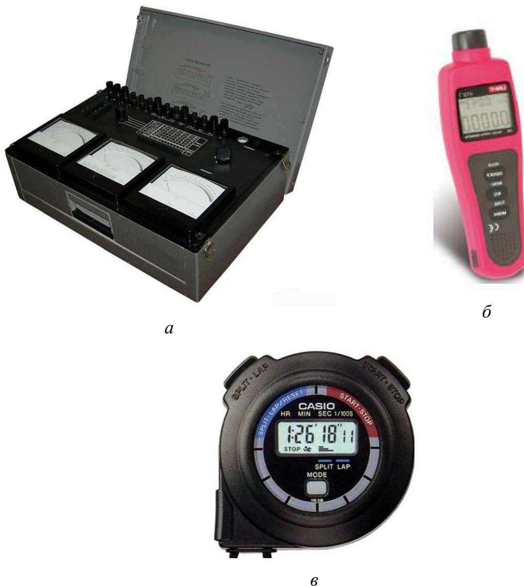
Рисунок 3.3 – Контрольно-измерительное оборудование экспериментальной установки: а – комплект измерительной аппаратуры К-505; б – ручной тахометр, в – электронный секундомер
