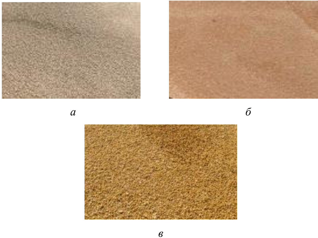
Рисунок 3.6 – Изображения для испытания разработанной системы при различной насыщенности желтого цвета зернового материала: а – 0,22 ед.; б – 0,31 ед.; в – 0,44 ед.
