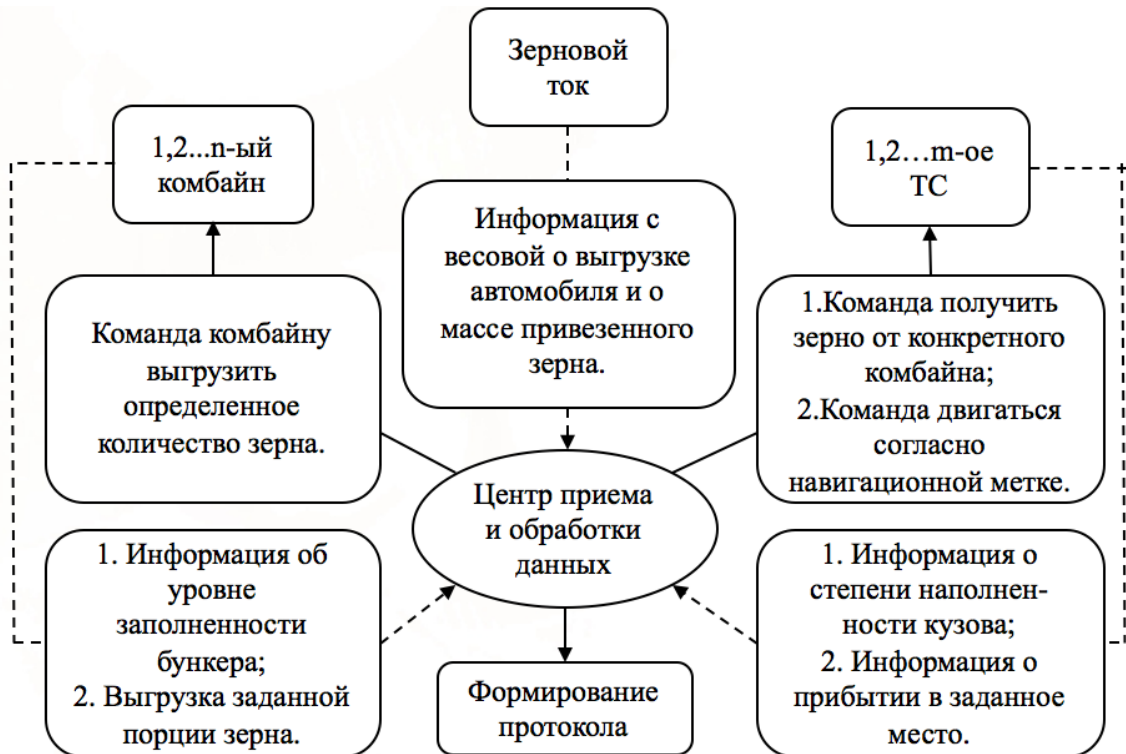
Рисунок 2.3 – Структура информационных потоков контроля и управления уборочно-транспортными процессами
