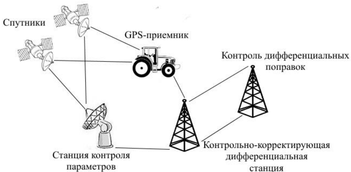
Рисунок 1.7 – Обобщенная структурная схема DGPS
