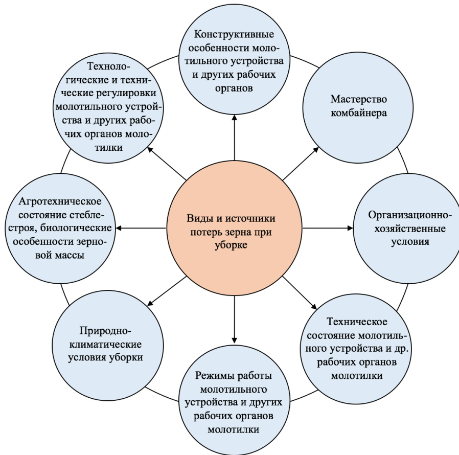
Рисунок 1.5 – Причины и факторы, обуславливающие количество потерь и механических повреждений зерна при уборке
