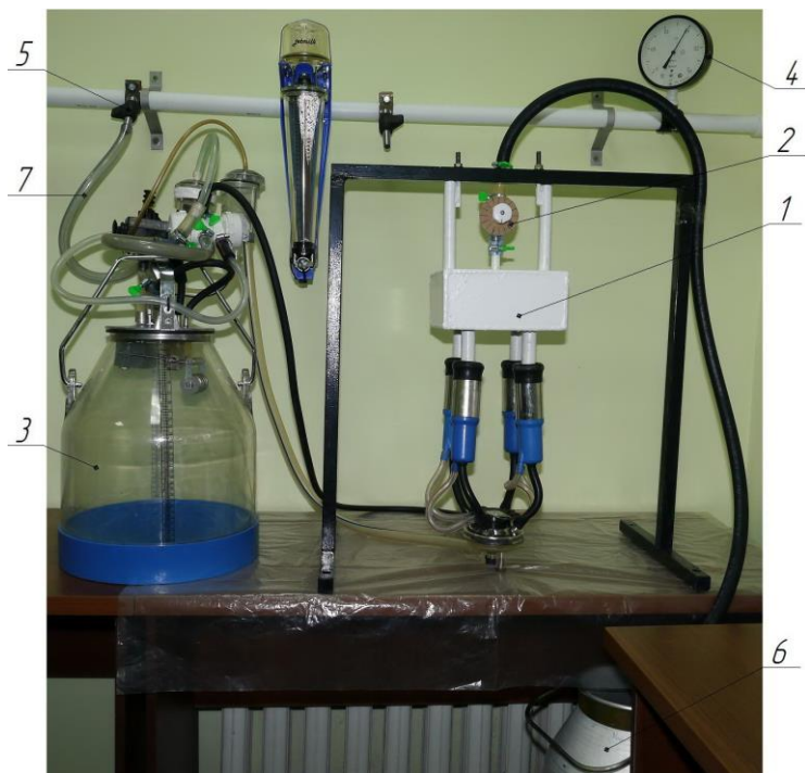
Рисунок 10 - Общий вид установки для определения времени отключения высокочастотного блока вибропульсатора: 1 – «Искусственное вымя»; 2 – тарированный кран; 3 – испытываемый доильный аппарат; 4 – вакуумметр; 5 – вакуумный кран; 6 – резервуар; 7 – соединительные шланги
