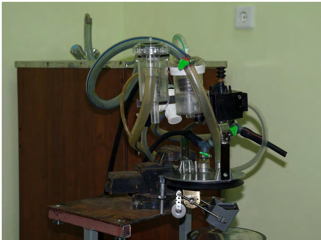
Рисунок 3.7 – Общий вид лабораторной установки для определения массы груза за молоколовушки блока управления режимом доения
