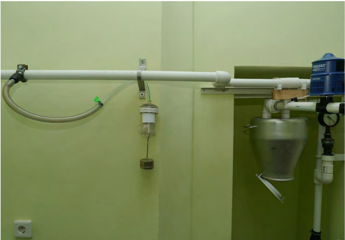
Рисунок 3.10 – Общий вид лабораторной установки для определения геометрических параметров устройства переключения магнитного клапана
