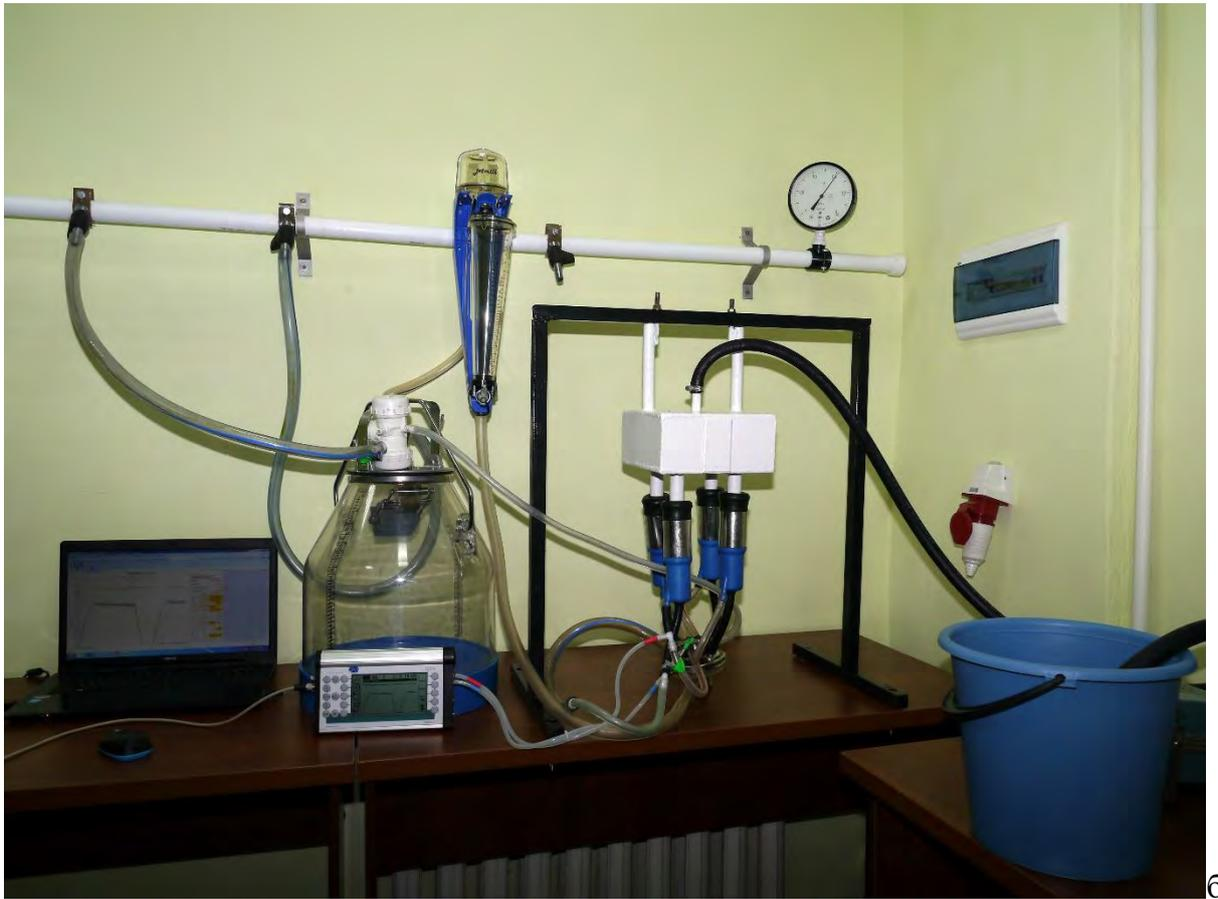
Рисунок 3.5 – Общий вид установки для определения пропускной способности доильного аппарата при выключенном (а) и включенном (б) высокочастотном блоке вибропульсатора и вакуумметрическом давлении соответственно – 48 и 38 кПа
