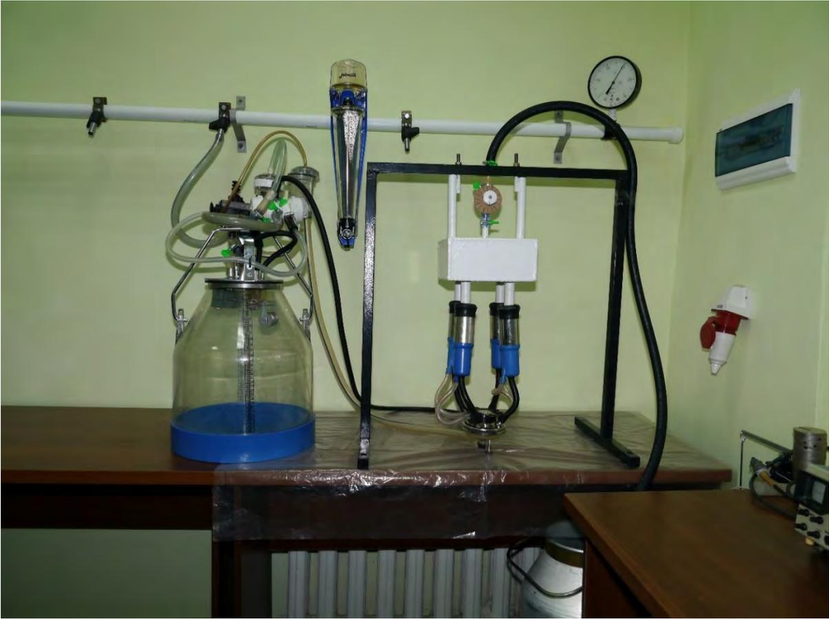
Рисунок 3.9 – Общий вид установки для определения времени отключения высокочастотного блока вибропульсатора
