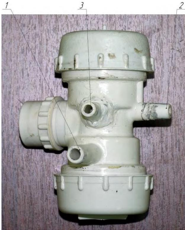
Рисунок 3.16 - Вибропульсатор с отключаемым высокочастотным блоком: 1 - патрубок постоянного вакуумметрического давления; 2 - патрубок переменного вакуумметрического давления; 3 - дополнительный управляющий патрубок
