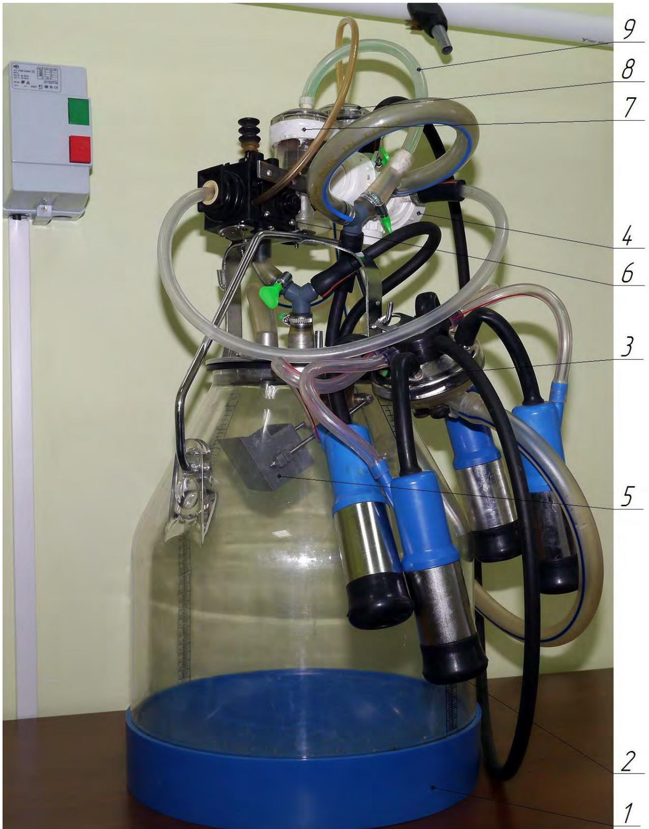
Рисунок 3.13 - Общий вид многофункционального стимулирующего доильного аппарата: 1 – доильное ведро; 2 – доильные стаканы; 3 – коллектор; 4 – пульсатор с отключаемым высокочастотным блоком; 5 – блок управления режимом доения; 6 – блок управления уровнем вакуума; 7 – устройство переключения магнитного клапана; 8 – приемник с мембраной дросселя; 9 – соединительные шланги
