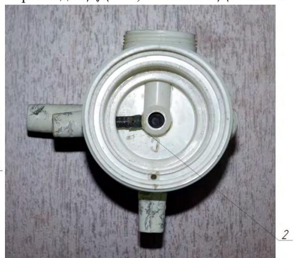
Рисунок 3.17 - Каналы в корпусе вибропульсатора: 1 - канал атмосферного давления низкочастотного блока; 2 - канал атмосферного давления высокочастотного блока
