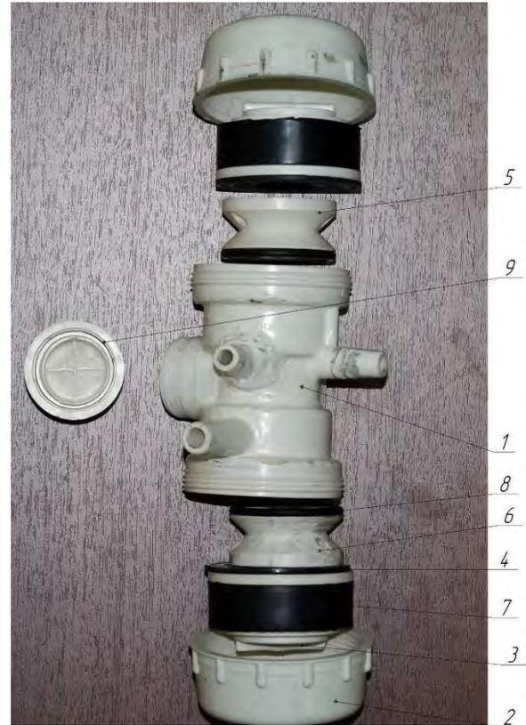
Рисунок 3.18 - Детали вибропульсатора: 1 - корпус АДУ-02.210; 2 - гайка АДУ.02.061; 3 - камера АДУ.02.052; 4 - мембрана АДУ.02.053; 5 - диффузор АДУ.020.055-01; 6 - диффузор АДУ.02.055; 7 - кольцо АДУ.02.056; 8 - прокладка ДД.013; 9 - гайка АДУ.02.062
