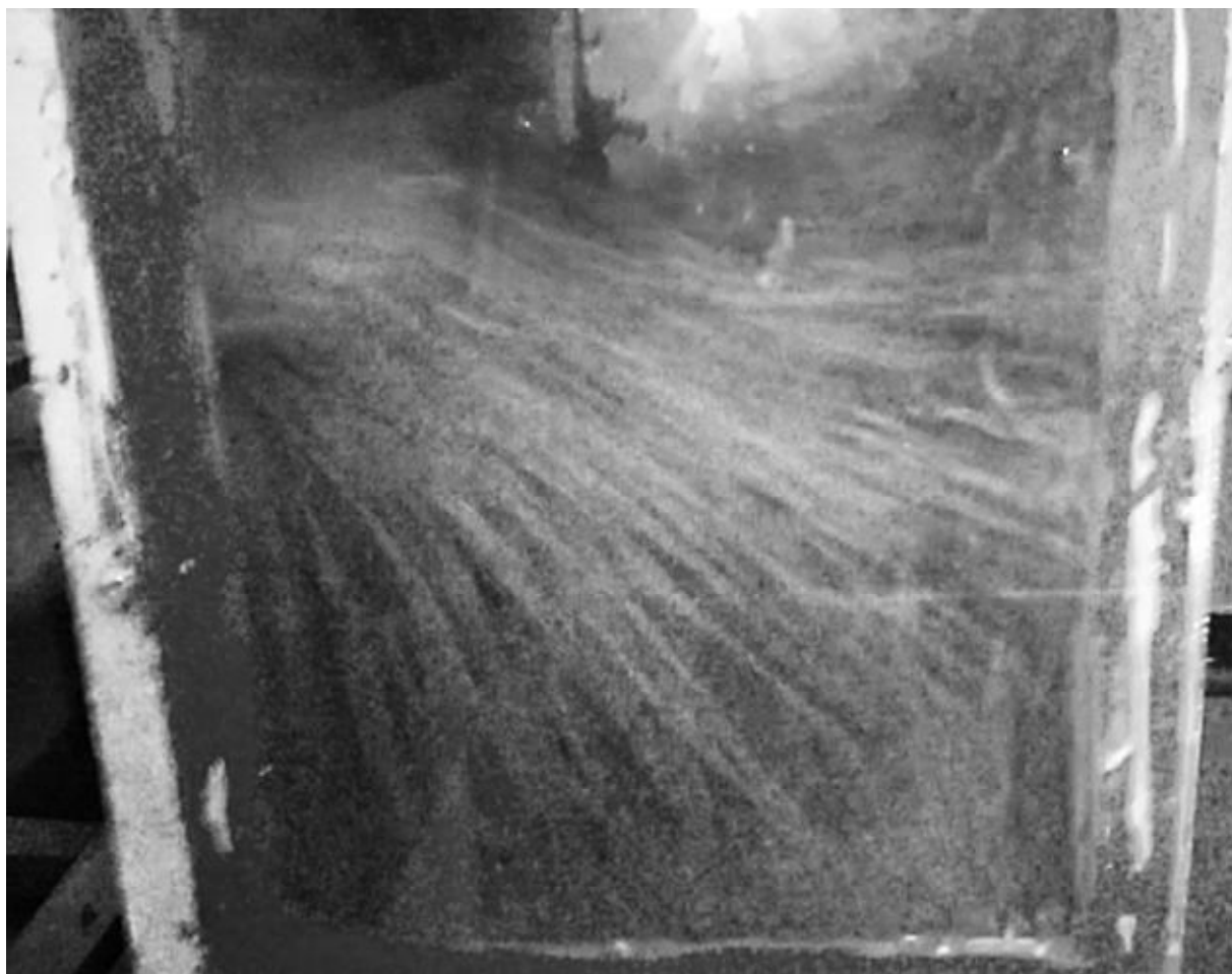
Рисунок 4.12 – Подача зернового вороха в пневмоканал питающим лотком со ступенчатой скатной поверхностью
