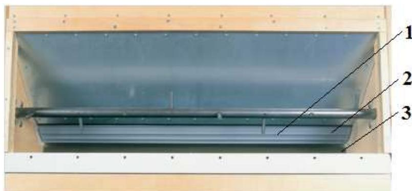
Рисунок 1.2 – Приемно-распределительное устройство с рифленным валиком:
