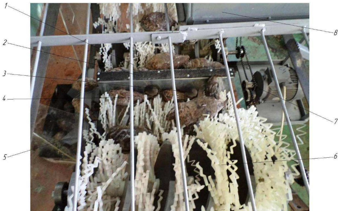
1 – камни; 2 – регулируемая заслонка; 3 – комки; 4 – корнеплоды свеклы; 5 – заслонка; 6 – гофрощеточные барабаны; 7 – привод; 8 - бункер Рисунок 3.7 – Технологический ворох в рабочем объеме установки
