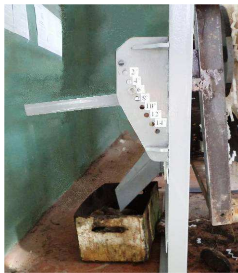
б) механизм наклона барабанов
