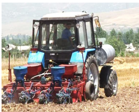
Рисунок 8 – Агрегат МТЗ-82.1+КМ-2,4 «Кишоварз»
