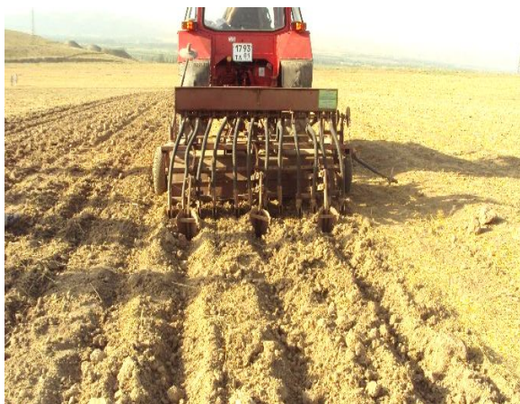
Рисунок 6 – Агрегат МТЗ-82.1 + КМ – 1,8 «Кишоварз» в работе
