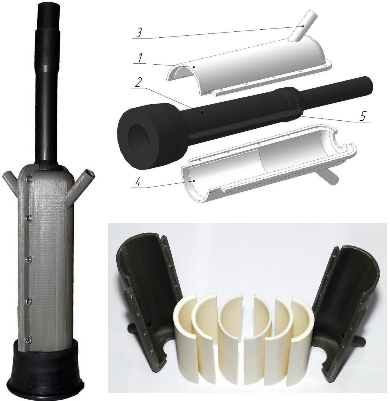
Рисунок 3.11 – Лабораторный образец доильного стакана для определения давления сосковой резины на сосок, выполненный на 3D принтере.
