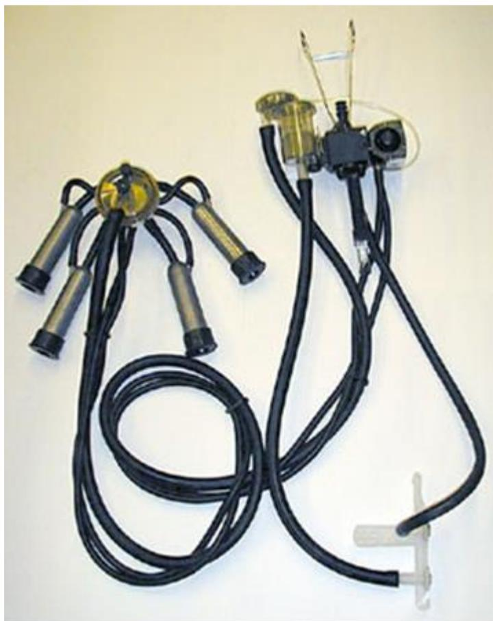
Рисунок 1.6 - Доильный аппарат «Нурлат» с двухуровневым вакуумом
