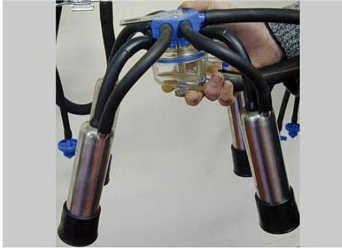
Рисунок 1.7 - Доильный аппарат «Унибокс» с системой одновременной пульсации (4x0)
