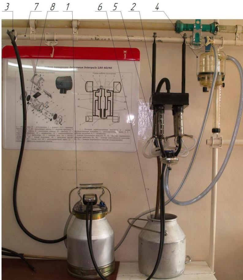
1 - доильный аппарат; 2 - стенд «Искусственное вымя»; 3 - кран; 4 - счетчик молока; 5 - доильные стаканы; 6 - резервуар; 7 - вакуумпровод; 8 - молочные и вакуумные шланги.
