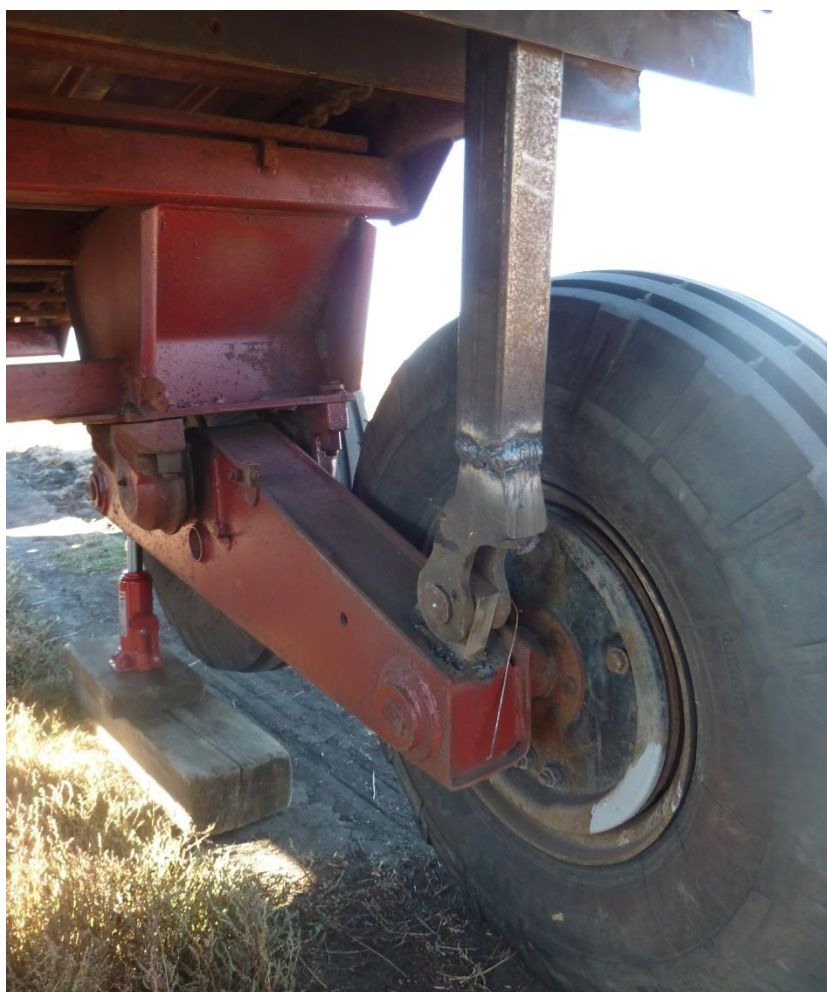
Рисунок 3.5 – Установка домкрата под передний конец балансира
