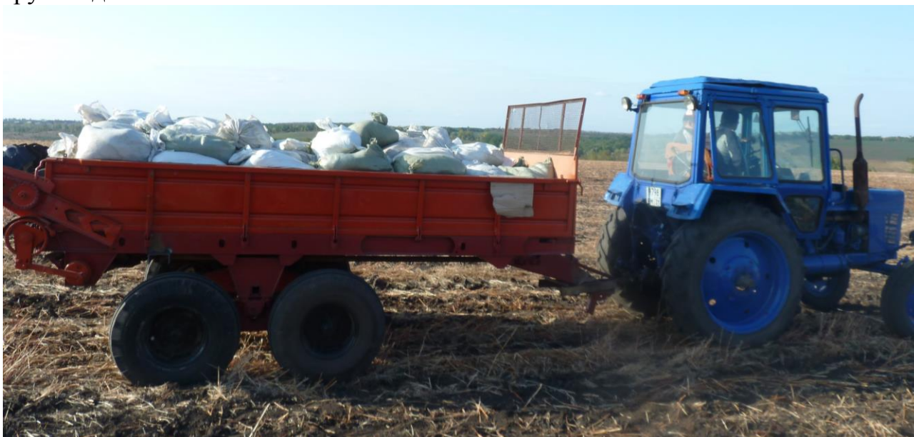
Рисунок 6 – Тракторный транспортно-распределительный агрегат МТЗ-80.1+РОУ-6 грузоподъемностью 6 тонн
