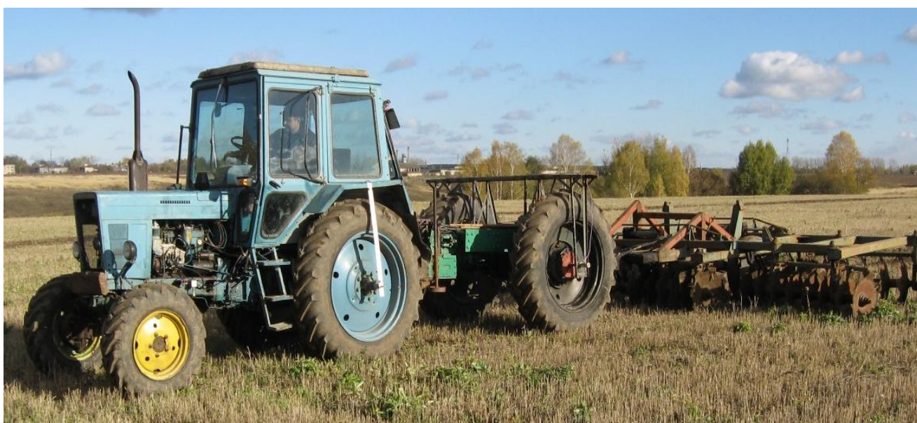
Рисунок 2.2 - Общий вид МТА на базе трактора МТЗ-82 с технологическим модулем и тяжелой дисковой бороной БДТ-7
