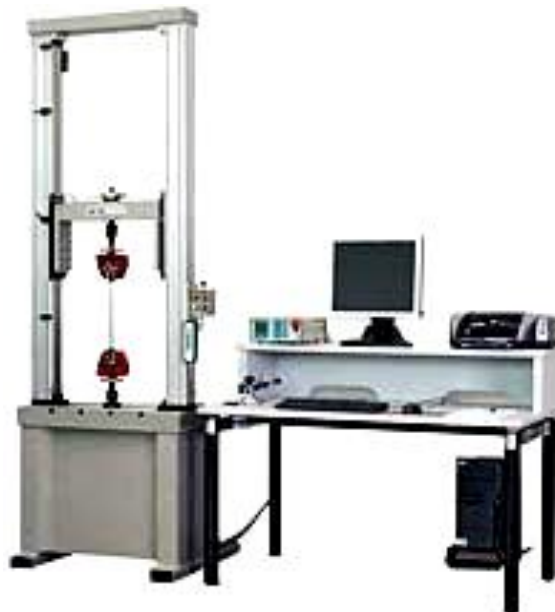
Рисунок Б. 1 – Общий вид испытательной машины LFM-100
