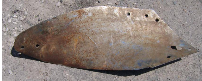
Рис. 1.4 – Сквозное изнашивание плоскости отвала плуга Gregoire Besson
