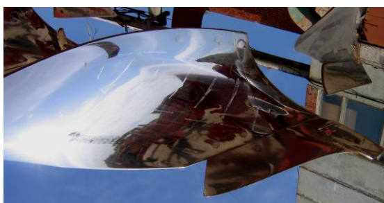
Рисунок 5.3 – Вид изношенного отвала (мелом штриховой линией обведена зона наибольшего изнашивания груди отвала)
