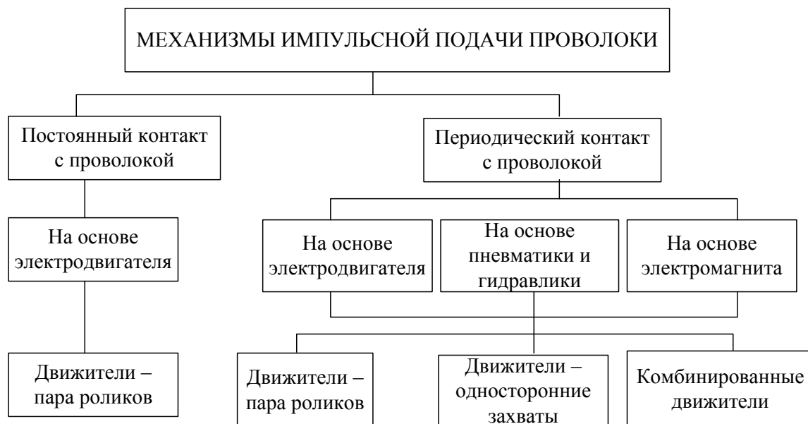
Рисунок 1.9 – Классификация устройств для реализации импульсной подачи присадочной проволоки по принципу их действия [123]
