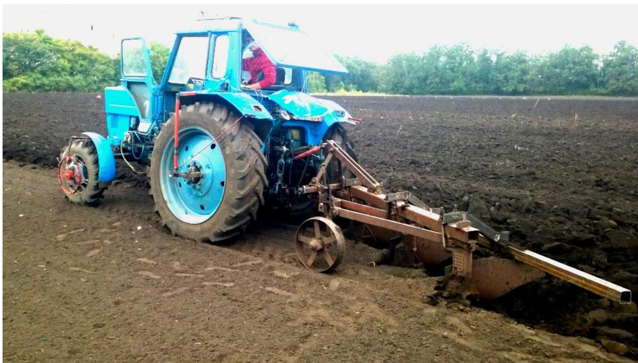
Рисунок 4.1 – Макет плуга на вспашке чёрного пара
