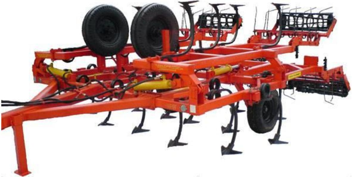
Рисунок 1.3 – Агрегат комбинированный чизельный АКЧ-4 (АКЧ-6, АКЧ-8) [1]
