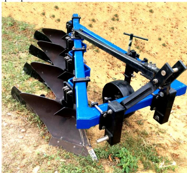
Четырёхкорпусный навесной плуг заводского изготовления с шириной захвата рабочих корпусов 35 см и общей шириной захвата 1,4 м. Оборудован приспособлением для полного оборота почвенных пластов методом расширения борозды. Приспособление представляет собой вертикальные щитки, установленные за рабочими корпусами с углом атаки к направлению движения. Угол атаки и глубина хода регулируются. Щитки являются съёмными. Плуг без предплужников, но поставлены углоснимы. Максимальная глубина обработки 28 см.
