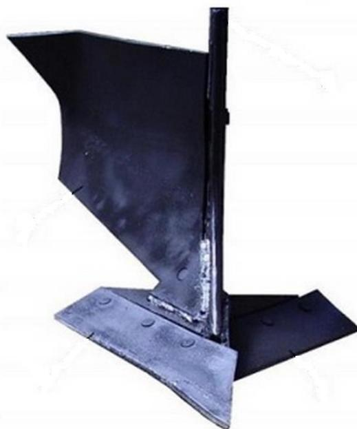
Рисунок 1.14 – Рабочий корпус плугов серии ПБС
