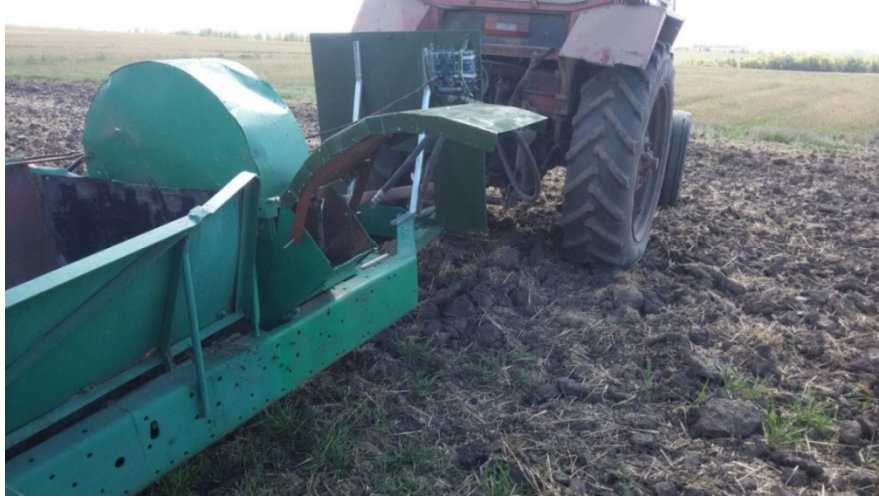
Рисунок 4.12 — Опытный образец дефлектора с радиусом 980 мм
