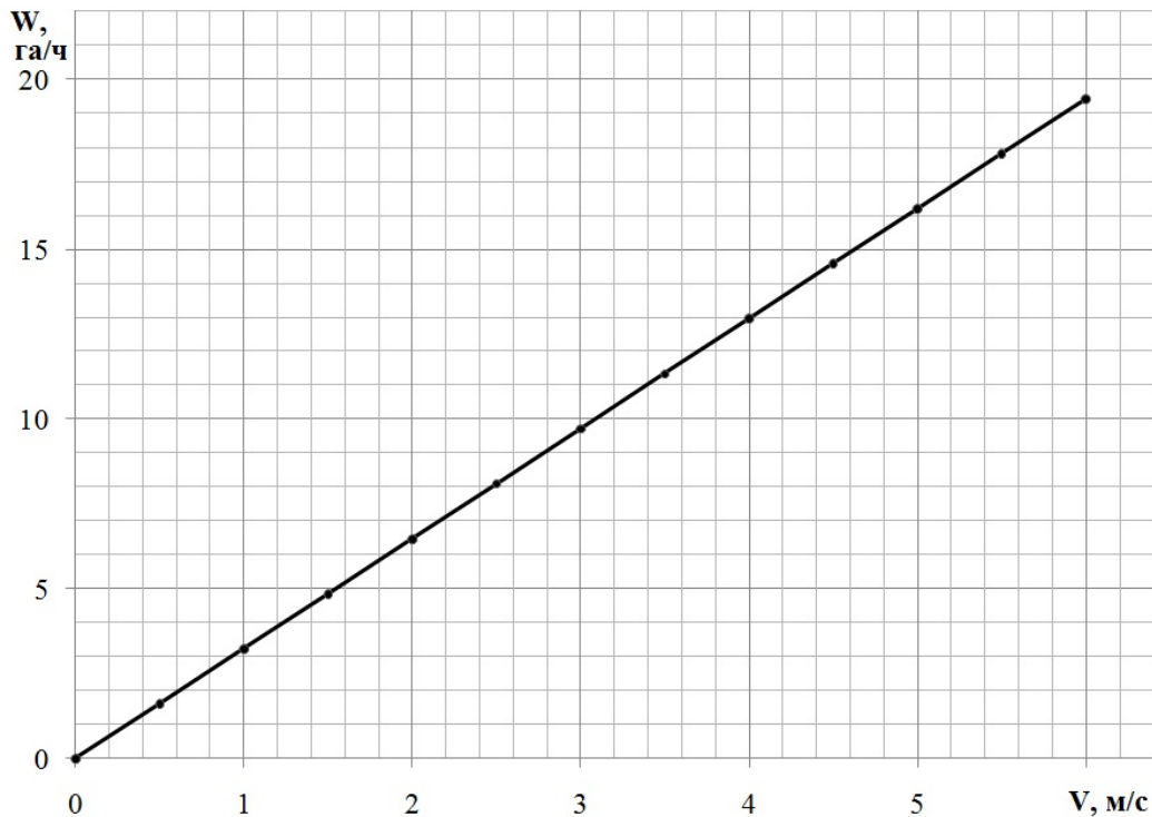
Рисунок 4.24 — Изменение производительности в зависимости от скорости движения агрегата
