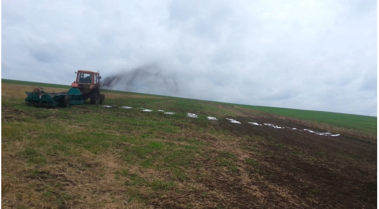
Рисунок 4.10 — Определение неравномерности внесения удобрений на стационаре
