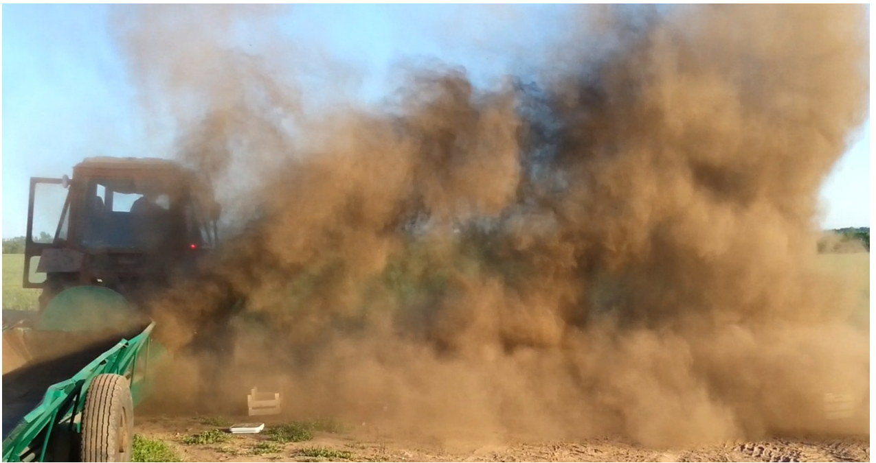
Пример вертикального веерного распределения частиц удобрений
