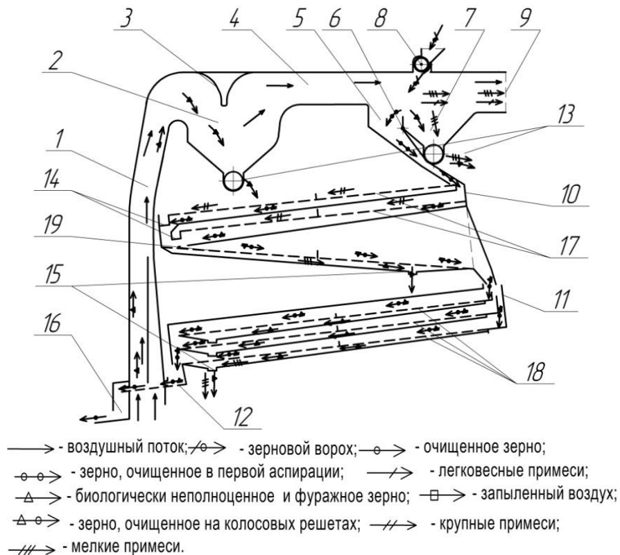
Рисунок 7.1 – Принципиальная схема машины:
