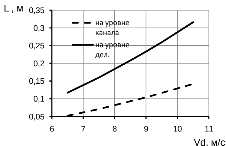
Рисунок 3.14 – Зависимость зоны распределения основной фракции в канале дорешетной очистки от скорости воздуха при вводе под углом 135°
