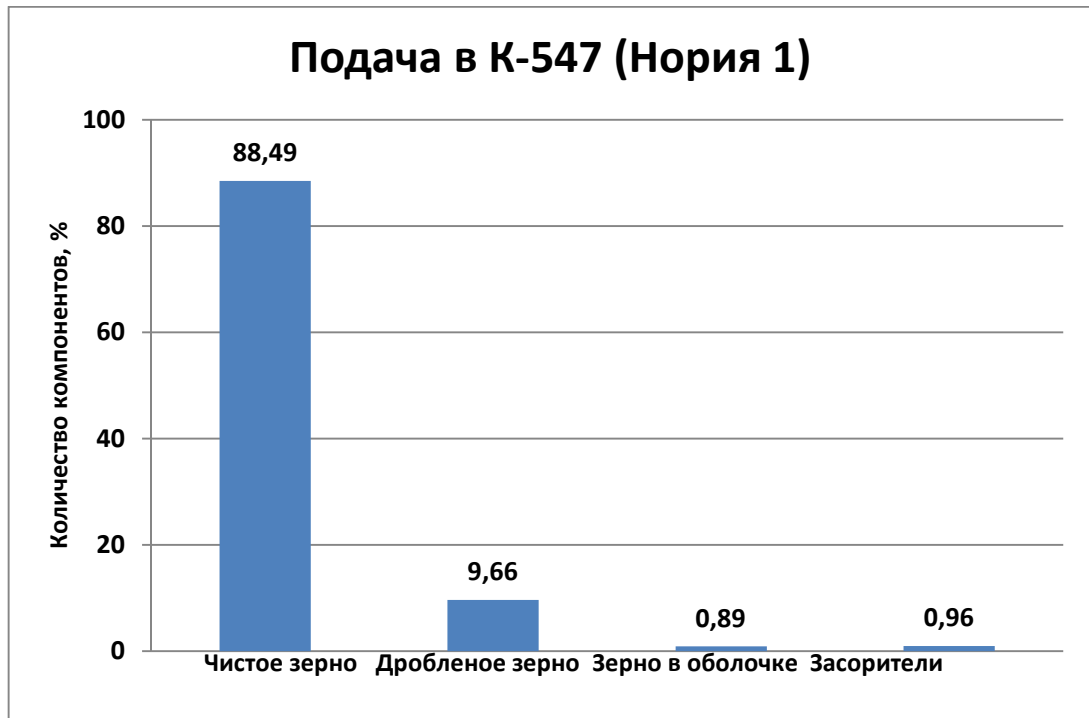
Рисунок 4.5 – Средневзвешенные показатели компонентов зернового вороха подаваемого в машину Petkus K-547
