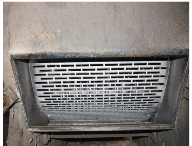
Рисунок 10 – Регулятор «живого» сечения в дробильной камере
