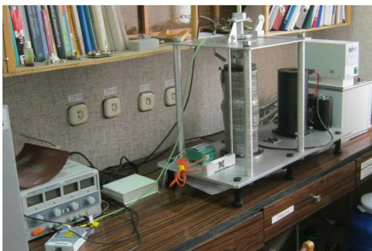
Рисунок 3.6 – Установка для определения прочностных, сдвиговых характеристик смазок
