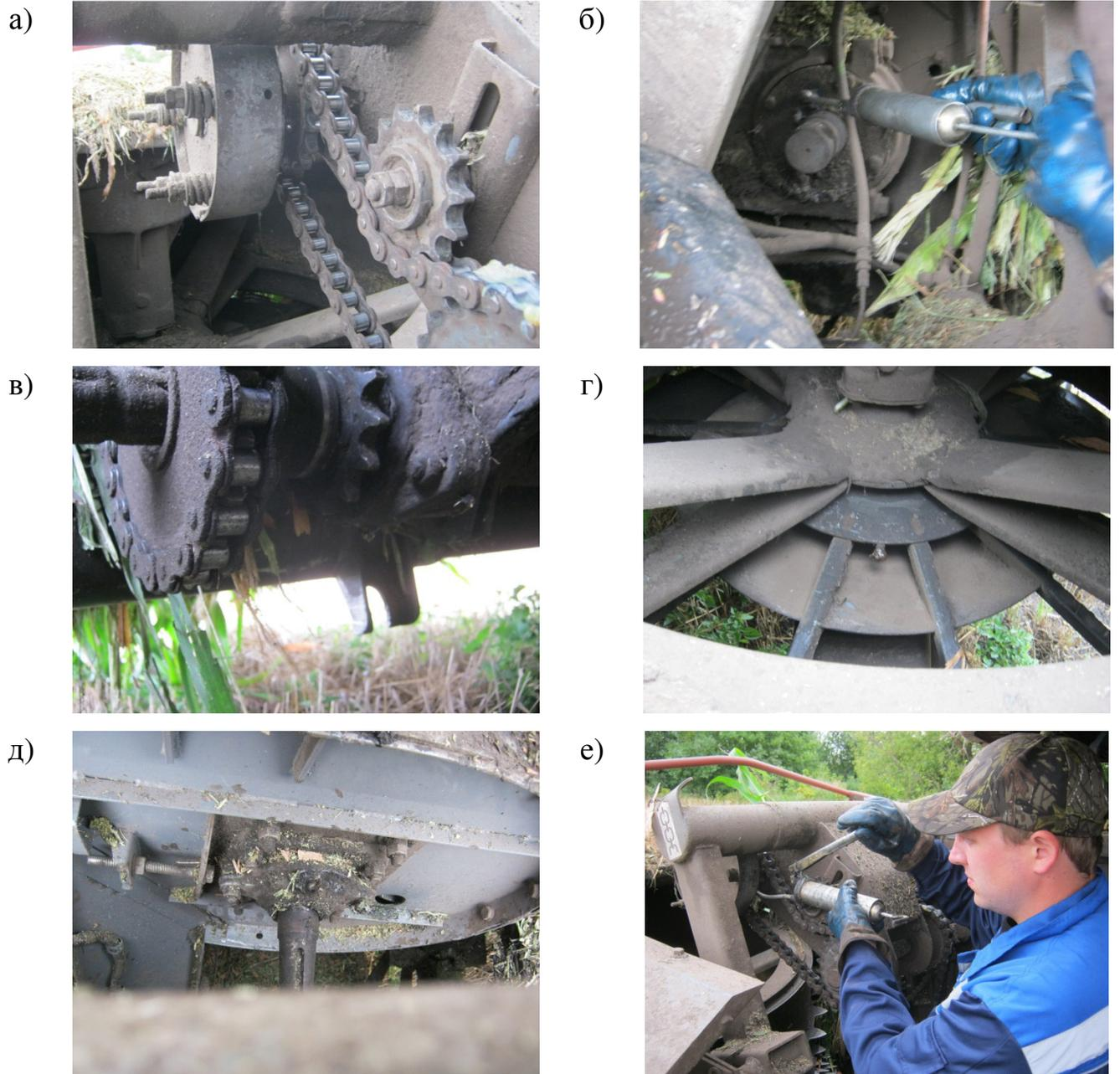
Рисунок 4.43 - Фрагменты узлов жатки комбайна Дон 680 М, смазываемых экспериментальной смазкой
