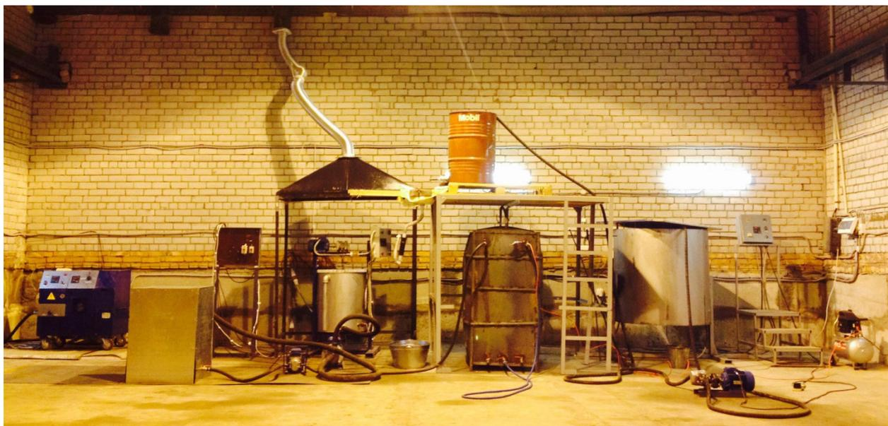
Рисунок 4.50 - Участок получения дисперсионной среды на основе отработанных масел и приготовления пластичных смазок
