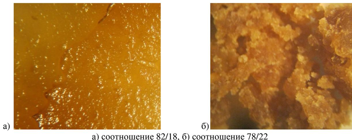
Рисунок 4.12 – Структура состава при смешивании дисперсионной среды и дисперсной фазы
