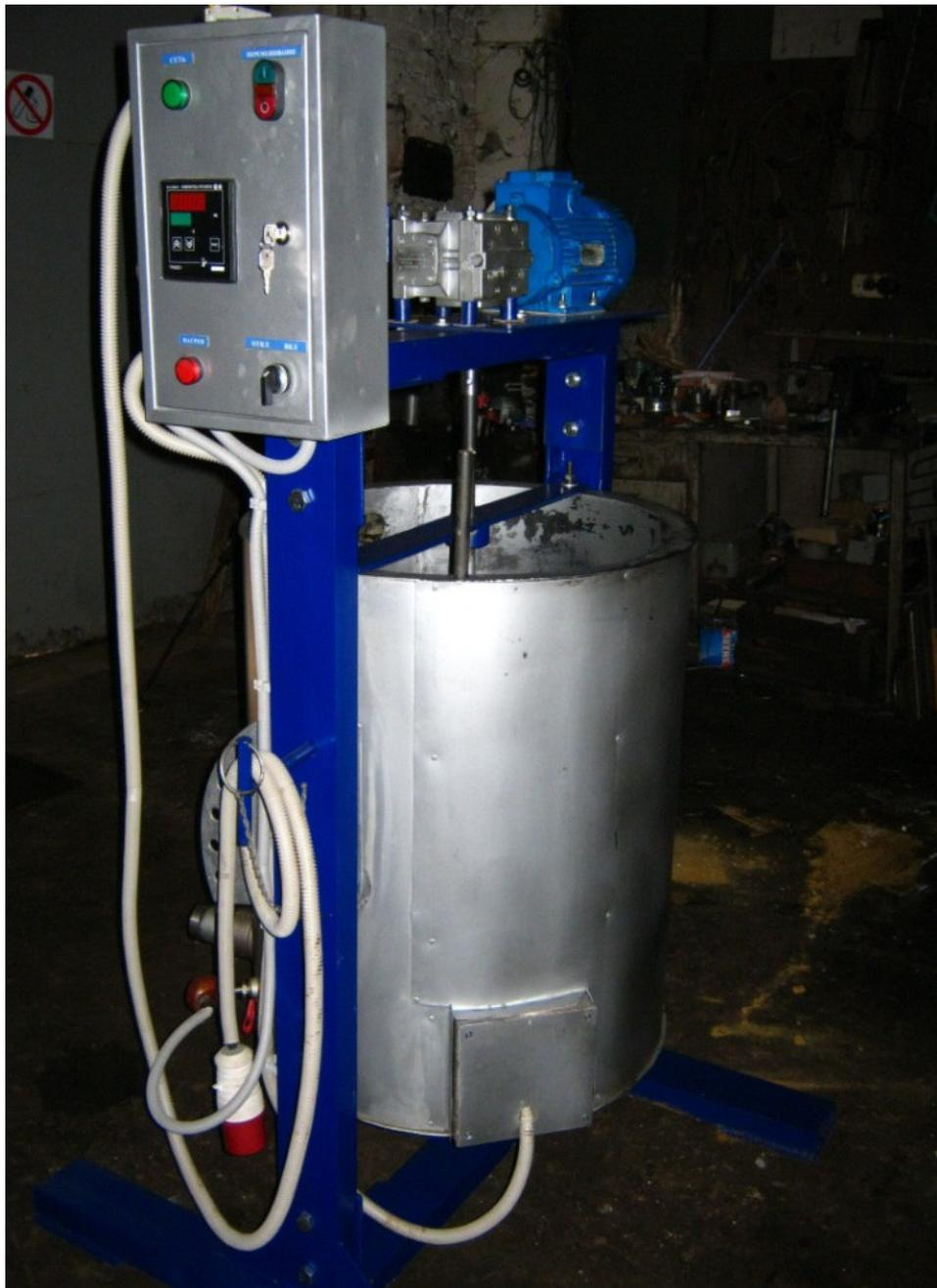
Рисунок 4.45 – Общий вид реактора – смесителя для приготовления смазок
