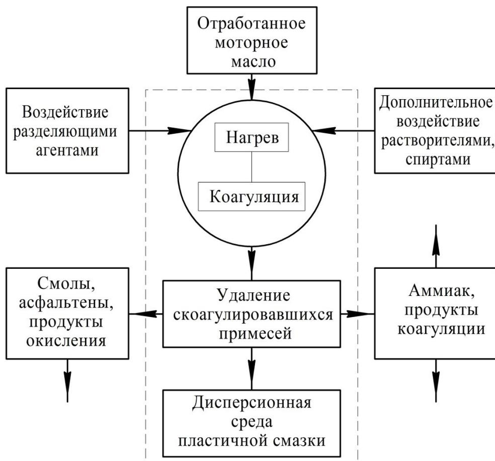
Рисунок 2.3 –Схема процесса получения дисперсионной среды на основе отработанных масел
