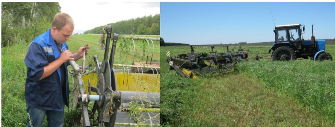
Рисунок 4.37 – Общий вид МТА при испытании смазок в опорных подшипниках жатки ЖВН-4.9
