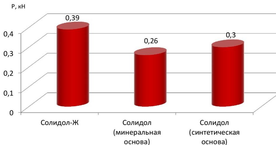
Рисунок 4.15 – Изменение усилия на отрыв пластин в зависимости от основы смазки Солидол при толщине слоя между пластинами 1 мм
