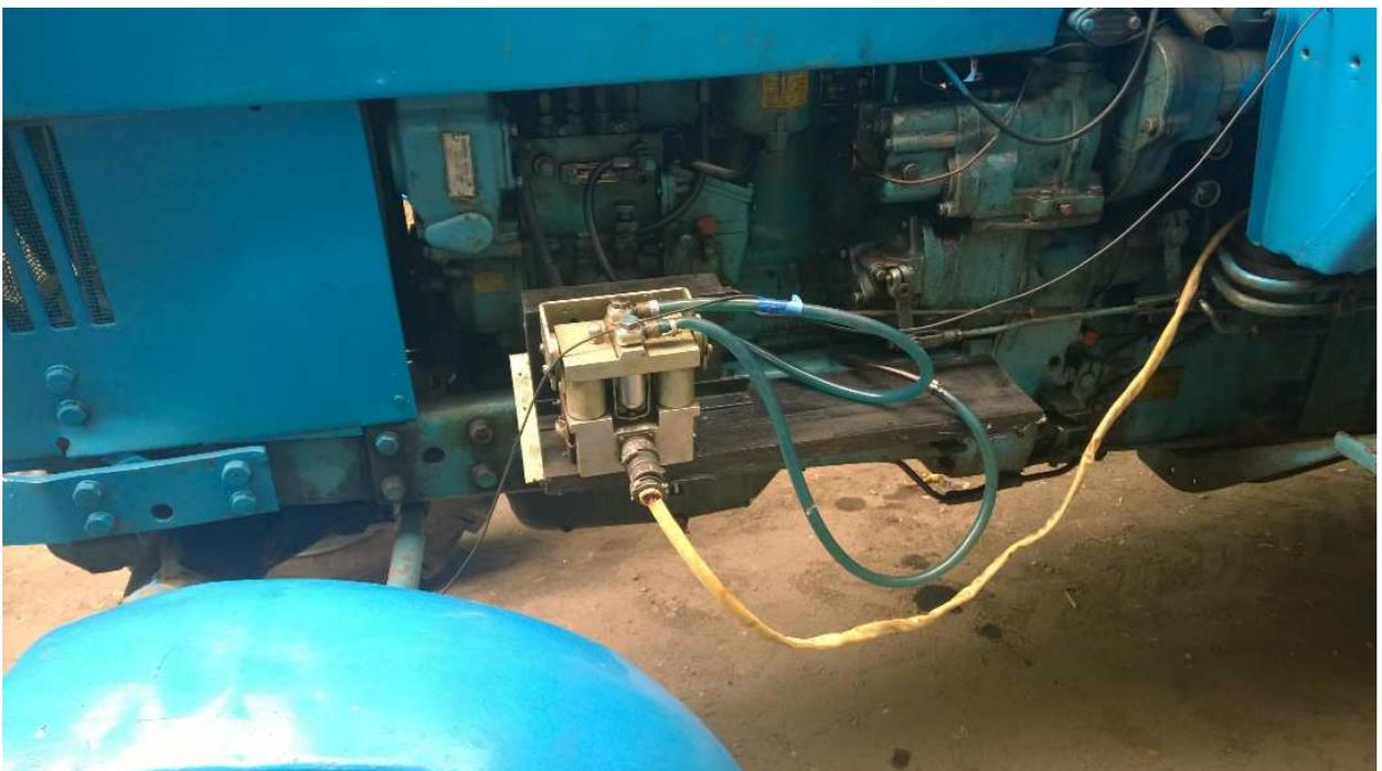
Рисунок 3.10 – Топливный расходомер марки ИП-154
