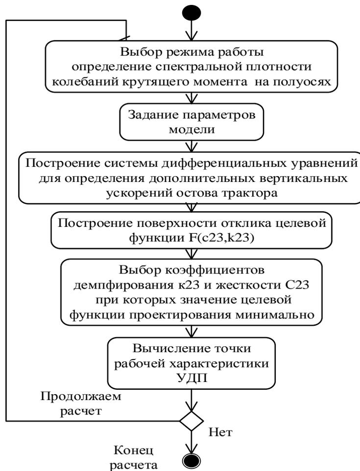
Рисунок 2.2 – Схема алгоритма определения рабочей характеристики УДП
