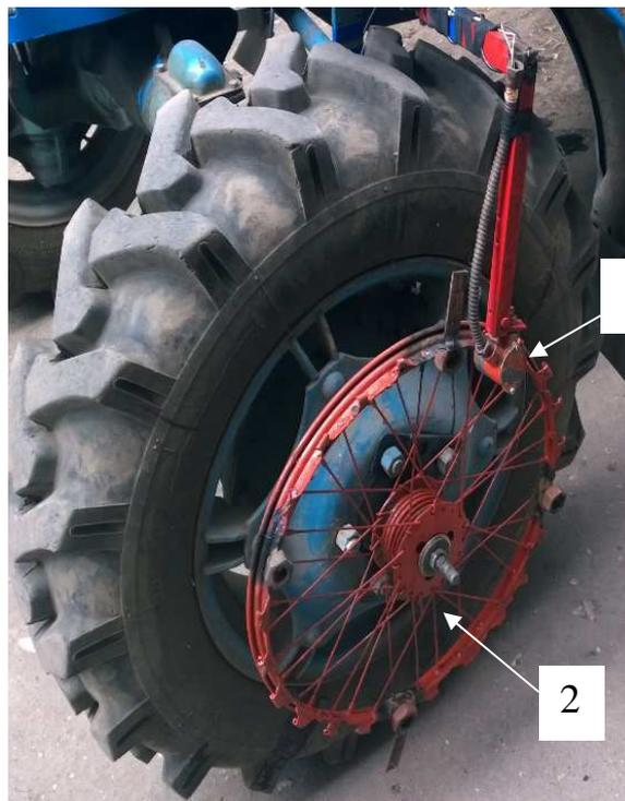
Рисунок 3.12 – Пятое колесо для измерения пройденного пути
