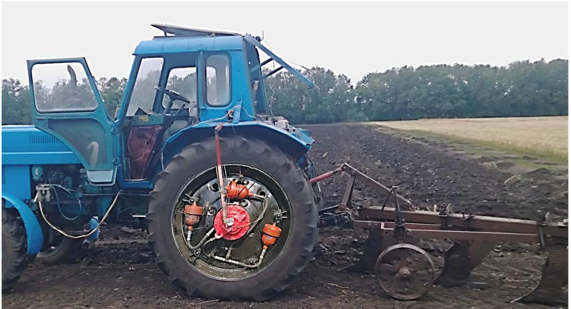
Рисунок 3.1 – Объект испытания с опытным приводом (МТА)
