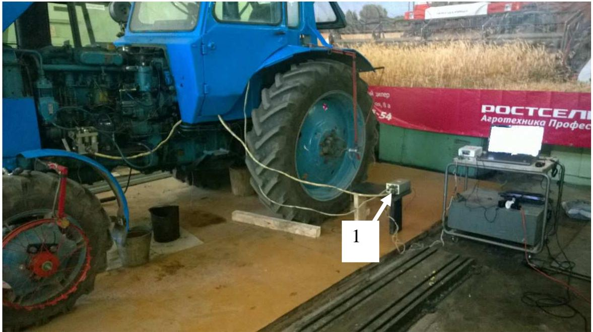
Рисунок 3.11 – Тарировка расходомера ИП-154
