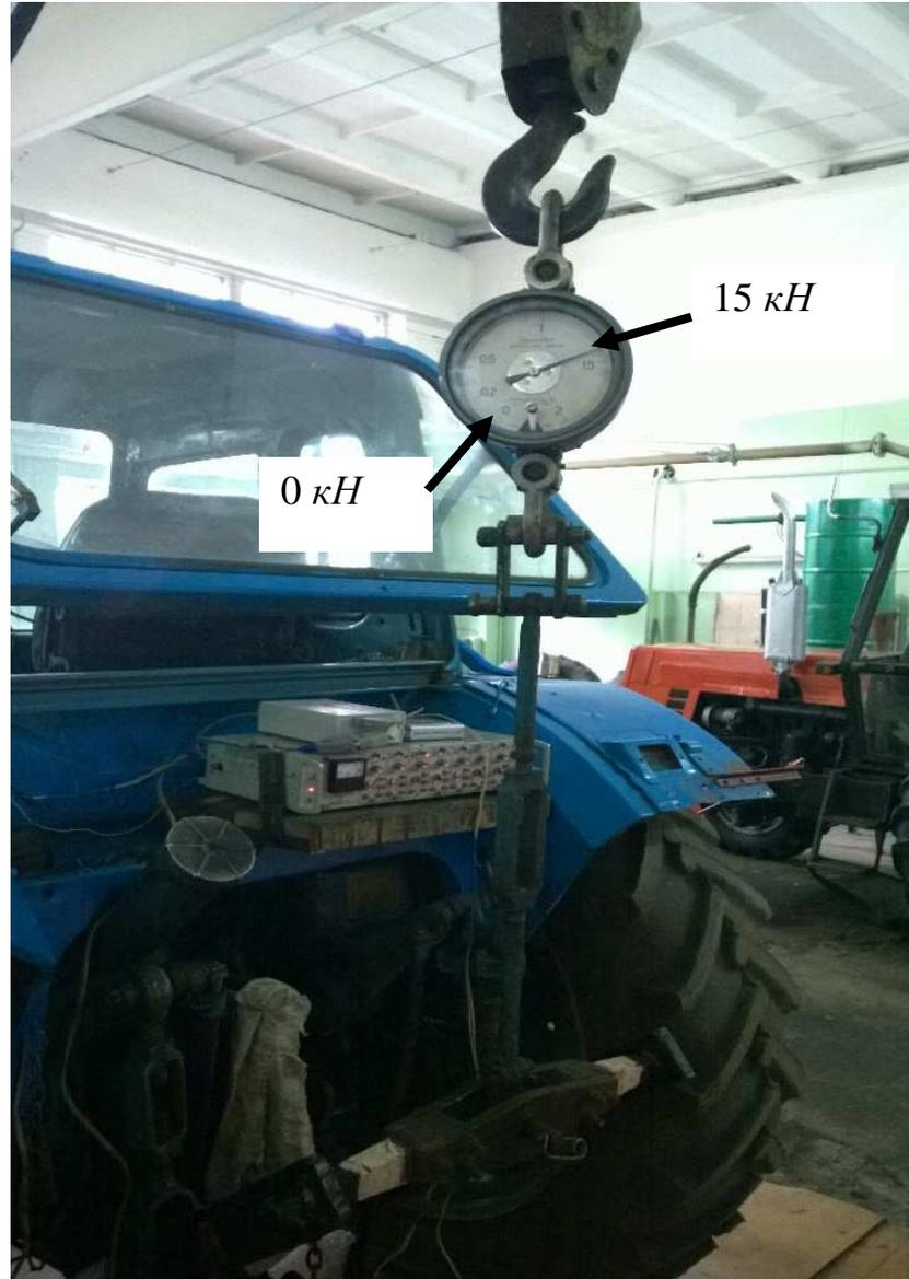
Рисунок 3.7 – Тарировка тензобалки навески трактора
