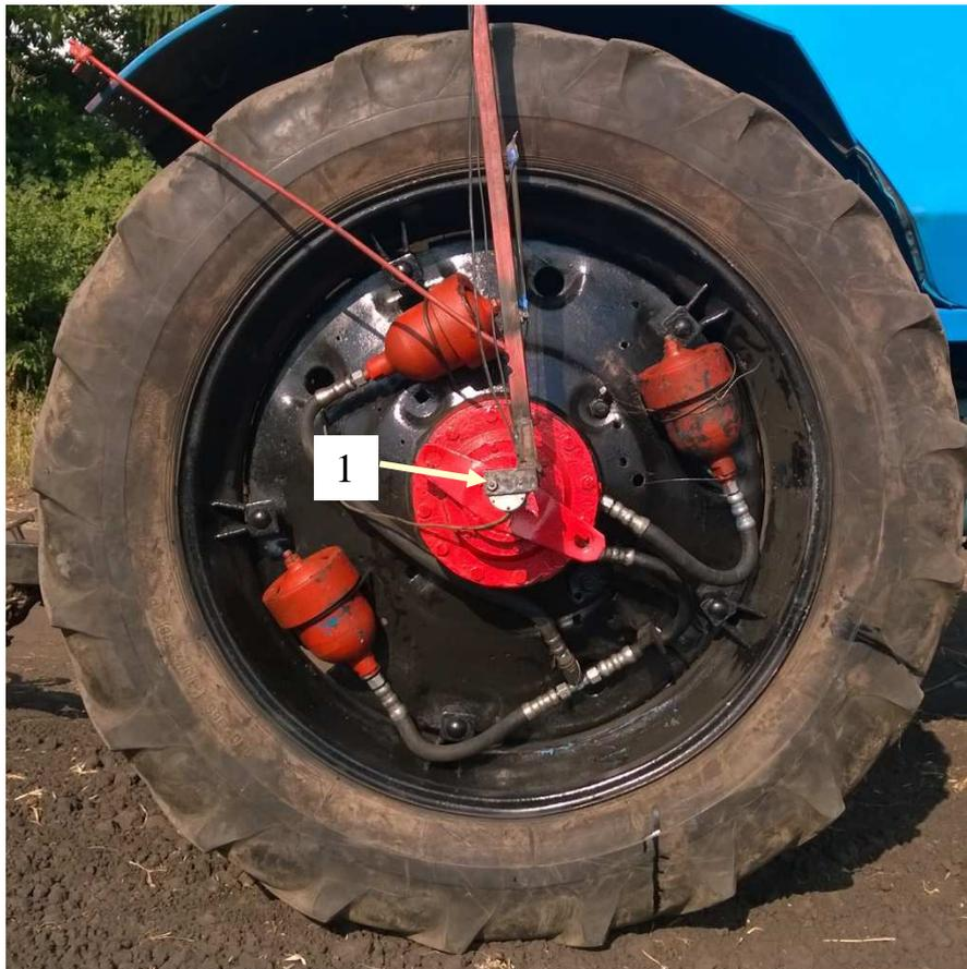
Рисунок 3.4 – Газогидравлический привод на ведущих колесах
