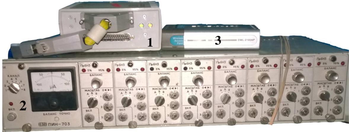
Рисунок 3.15 – Тензоизмерительные приборы, устанавливаемые на тракторе
