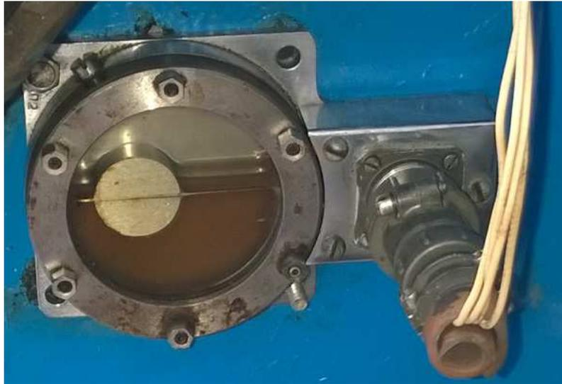
Рисунок 3.9 – Тензометрический акселерометр марки АТ-1
